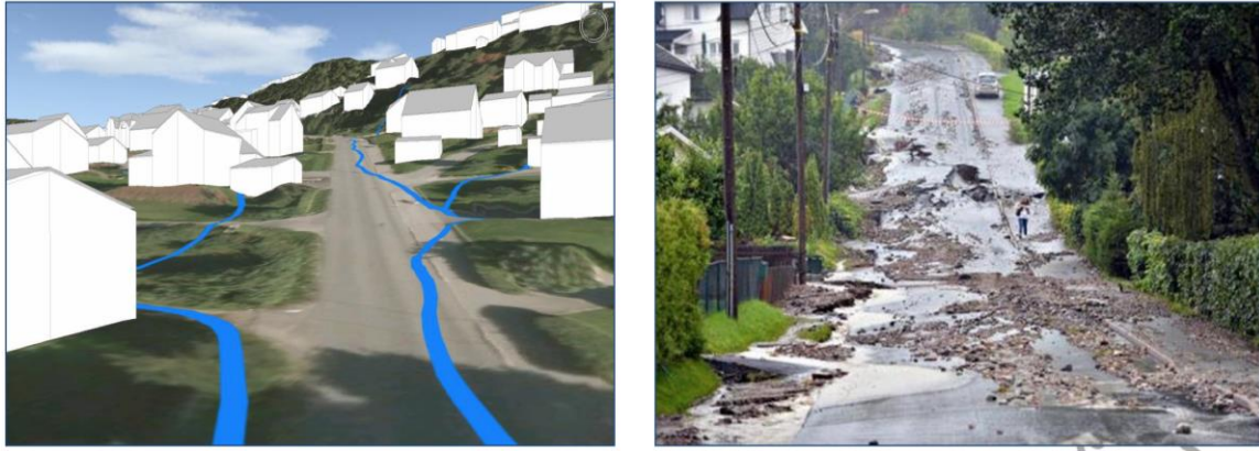
Figur 19: Avrenningsmodell til venstre, flomskader til høyre i nedre Eiker kommune (Brokhaug 2016).
