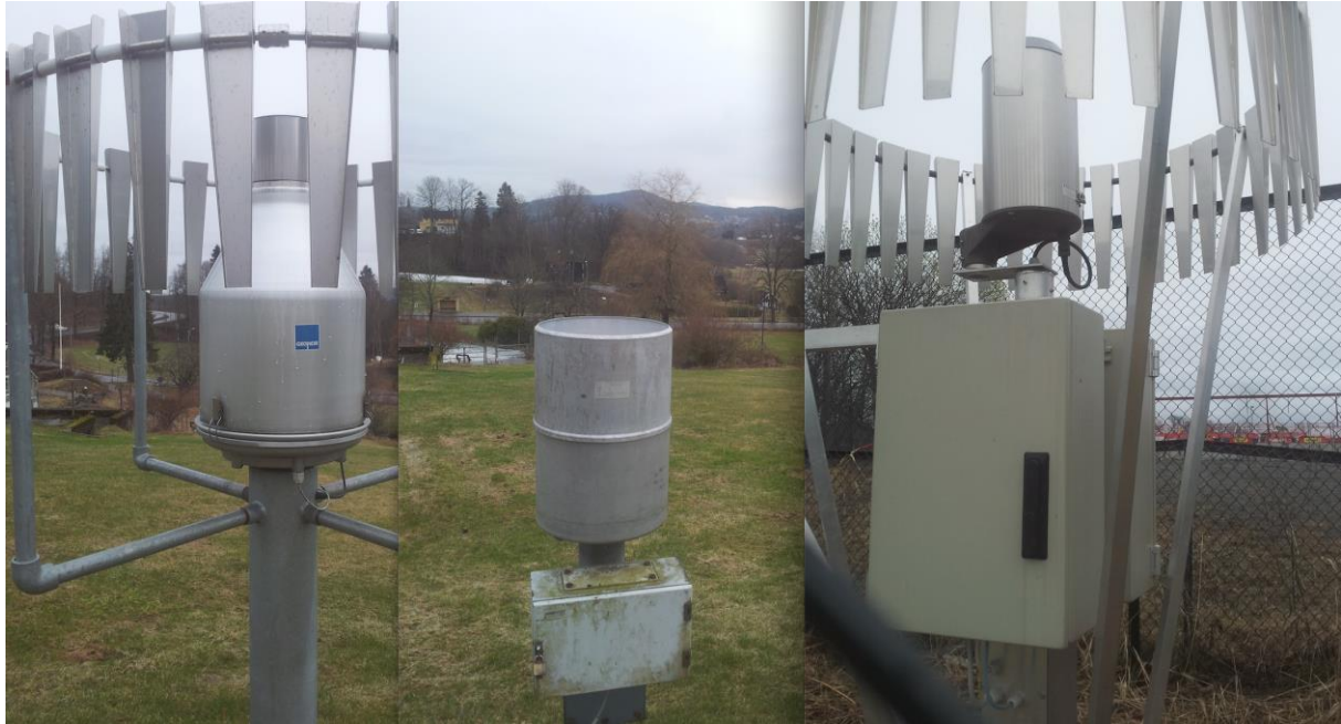
Figur 28: Bilder av de forskjellige nedbørmålerne. Til venstre er den nye nedbørmåleren på målestasjonen ”Sem”. Det midterste bildet er den gamle nedbørmåleren på Sem og til høyre er et bilde av målestasjonen ”Brannstasjonen” (Deggerdal 2016a).
