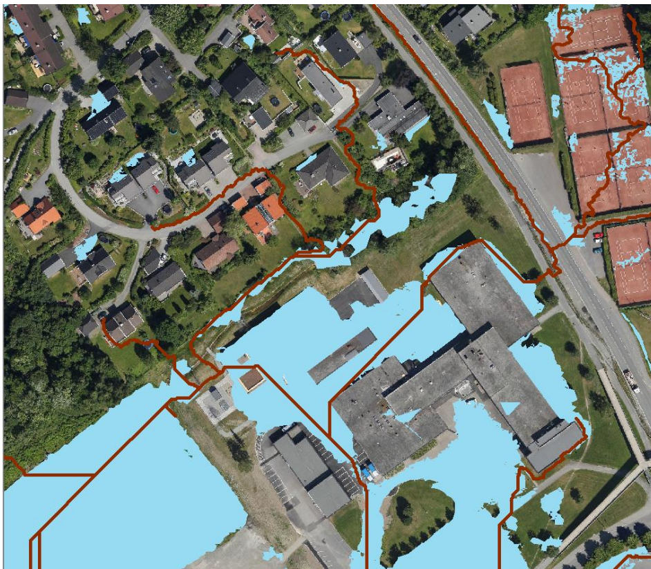
Figur 24: Røde streker er avrenningsveier på overflaten og de blå feltene er området i fare for opphoping av vannmengder (Gulbrandsen 2016). Bleiker videregående skole er de store byggene i midten av bildet. På venstre side av bilde er en kunstgressbane som også er utsatt for akkumulert avrenning, på høyre side er utendørs tennisbaner.
