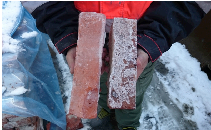
Figur 2-5: Teglstein til høyre er en hardbrent fasadestein og er tydelig mørkere nede i høyre hjørne (Foto: Anita Spjøtvold)
