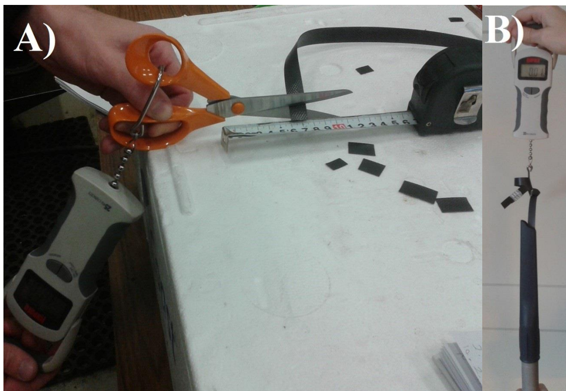
Figur 6.5: Forsøk utført med stropp, fiskevekt og saks i bilde A, og med stropp, fiskevekt og støvsuger i bilde B
