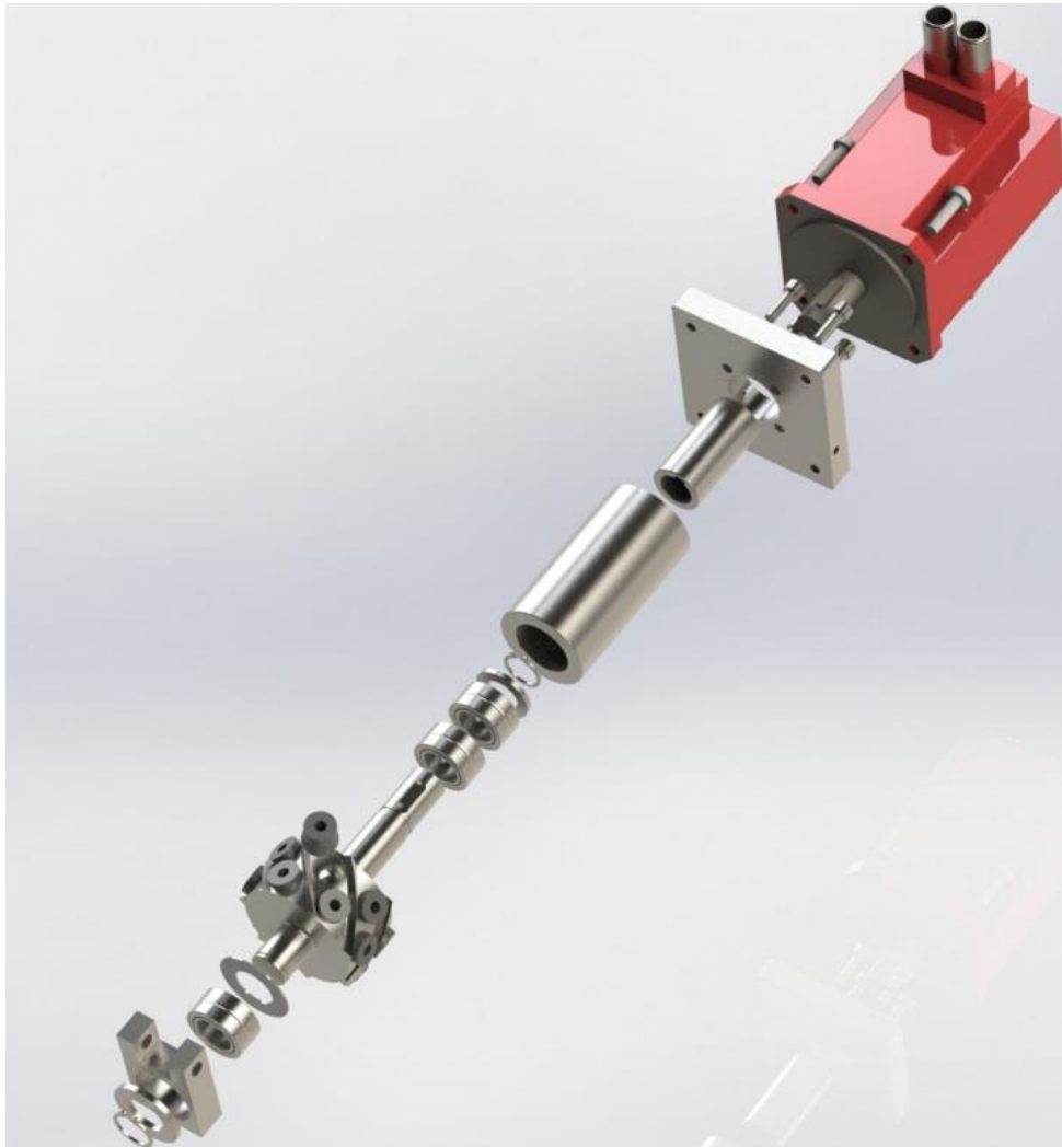
Figur 11.1.12: Eksplosjonstegning som viser knivrulle, motorfeste, motor, hylse, lagerhus og diverse lagre og låseringer.
