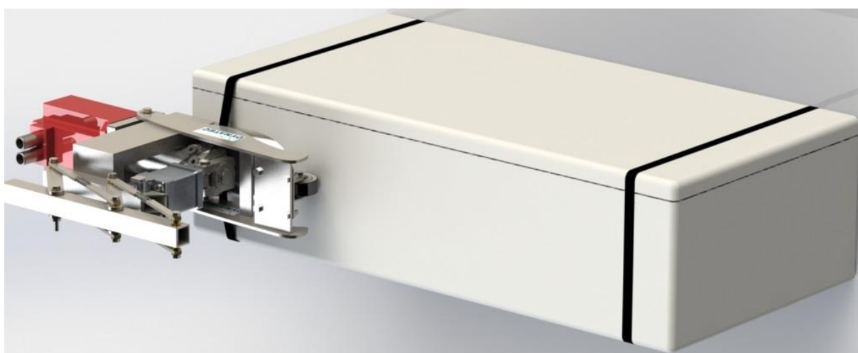
Figur 11.1.5: Her ser man hvordan stroppefjernerer vil fungere i en fabrikk. Stroppefjernerer står i ro, mens den hvite fiskekassa beveger seg mot venstre i bildet. Når den første stroppen er fanget opp og kvernet, går den videre til neste stropp.
