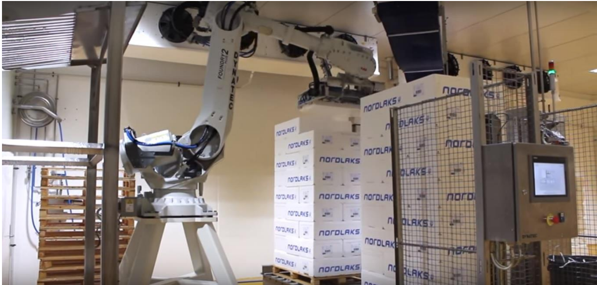
Figur 1.2: Depalletering av fiskekasser der stroppene er fjernet manuelt 36 ).
