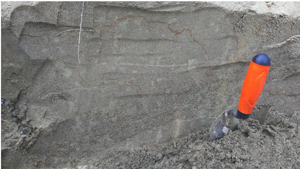
Figur 4.11: I et lite snitt i en veiskjæring langs en traktorvei like vest for det undersøkte georadarprofillet på lokalitet 2 består de øvre sedimentene av godt sortert sand.
