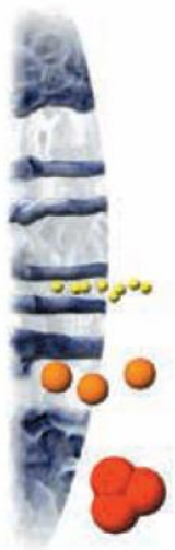
Figur 3.4.3 Separasjon av molekyler med ulik størrelse i en SEC-kolonne (GEHealthcare 2006).
