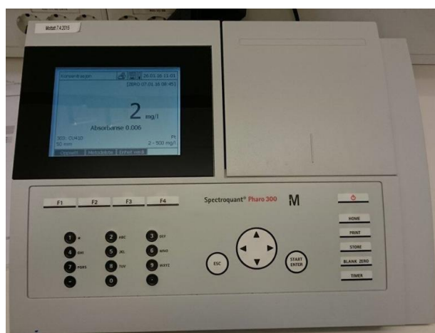
Figur C- 1: Spektrofotometeret Pharo 300 under fargemåling 26.01.2016.
