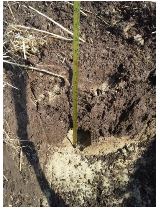
Figur 44. Hullet etter dreneringskon som ble funnet våren 2014 etter løsning høsten 2013
