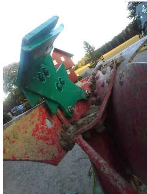
Figur 19 Kverneland Økoskjær montert på plog sett bakfra
