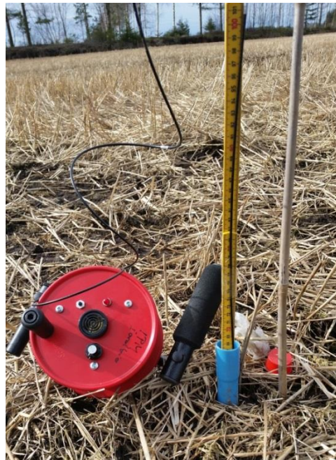
Figur 14 Utstyr brukt for å registrere grunnvannstand
