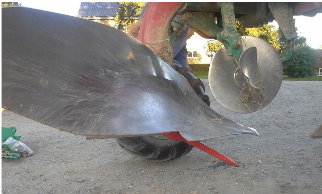
Figur 22 Løsnetinde montert på plog sett fra siden
