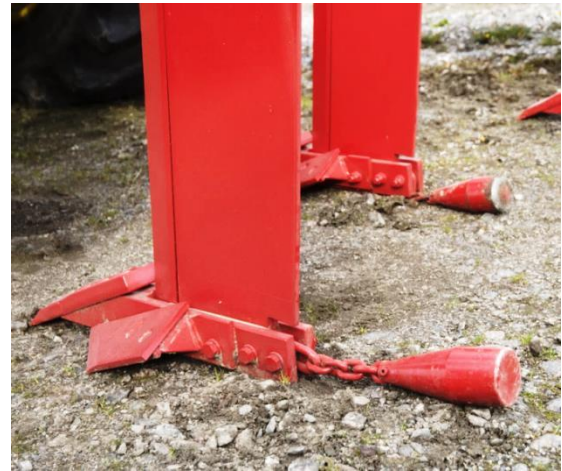
Figur 17 Kverneland CLE løsnetinder med vinger og dreneringskon Foto: Håvard Simonsen
