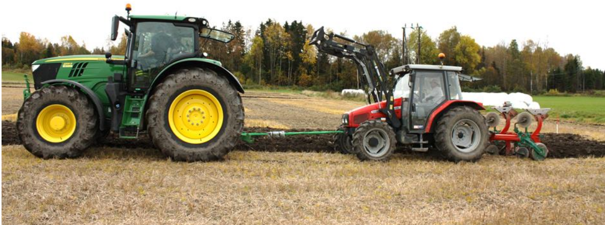
Figur 23 Trekkraftmålinger med traktorer og plog
