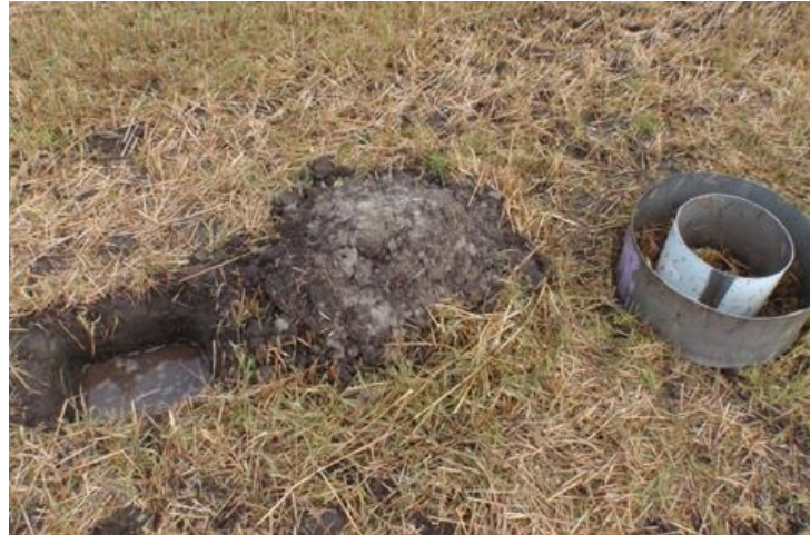
Figur 43. Infiltrasjonsmåling der vannet rant til hullet som var gravd til venstre i bildet
