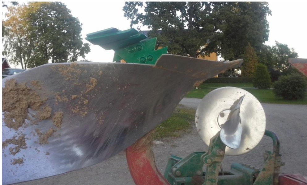
Figur 20 Kverneland Økoskjær montert på plog sett fra siden
