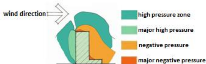
Figur 1. Vind lager ulike lufttrykk i ulike høyder og områder av en bygning (modifisert figur av Ken Yeang)
