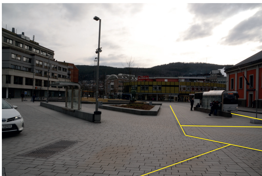
Figur 4.47 Holdeplassen for taxi er ikke en del av ledelinjesystemet, som er fremhevet i gult.
