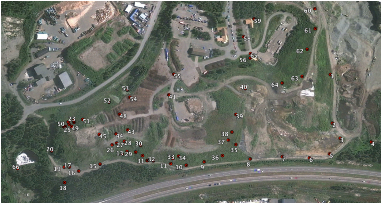
Figur 6 Dei raude punkta markerar kvar det er plassert ut mosenett på Solgård avfallsplass. Kwart punkt er merke for to nett, eit ved om lag 45 cm og eit ved om lag 80 cm over bakken, festa med ca 15 cm fiskesnøre til brøytestikker.
