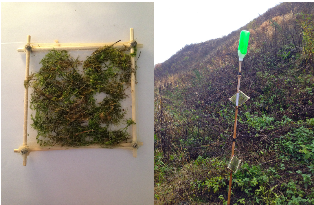
Figur 5 Til venstre: Mosenett, 10 cm x10 cm, før dei blei plassert ut. Til høgre: Mosenett hengt opp ved 45 cm og 80 cm, på ei brøytestikke på deponiet.
