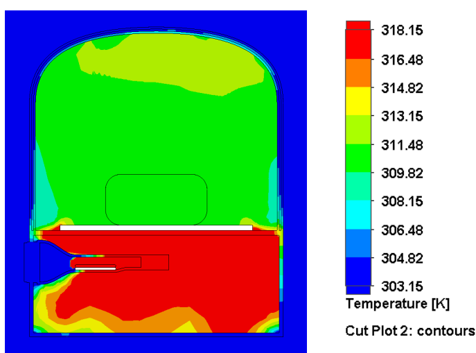
Figur 81: Plottet viser en jevn temperaturfordeling inne i kuvøsen. Plottet er gjort midt i kuvøsens lengderetning. Temperaturskalaen går fra 30-60 °C (303,15–333,15K). Omtrent hele tverrsnittet som er plottet ligger i det grønne området som strekker seg fra 36,7 – 38,3 °C (309,82-311,48 K) på skalaen. Forsøk 4 viser mye jevnere fordeling av temperaturen inne i kuvøsen sammenlignet med forsøk 2 (Figur 72).
