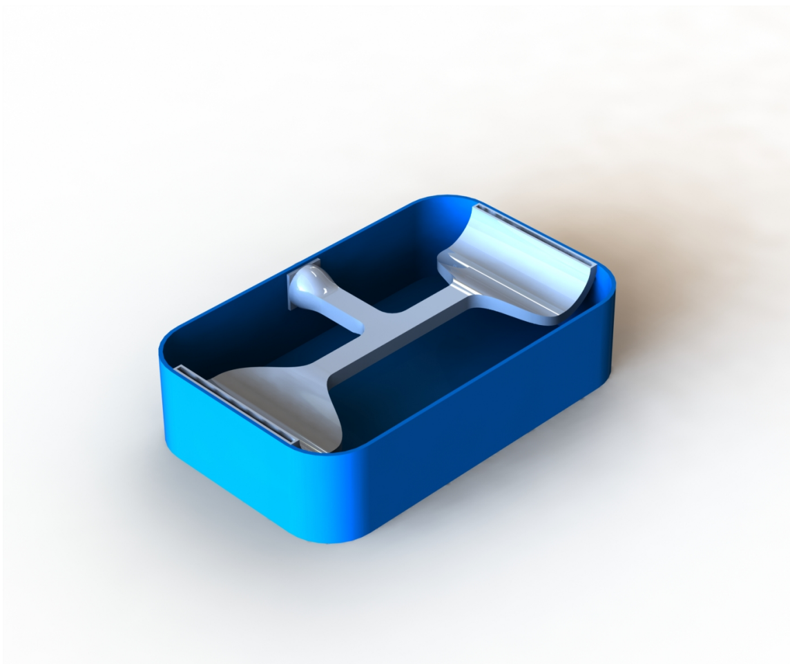
Figur 93: Kuvøsebunnen med luftkanalen som leder lufta inn i kuvøsen. Luftkanalen er tilkoblet vifta som leverer friskluft til systemet. Kuvøsens varmeelement ligger inne i kanalen og varmer opp lufta før denne sendes inn i kuvøsetoppen.
