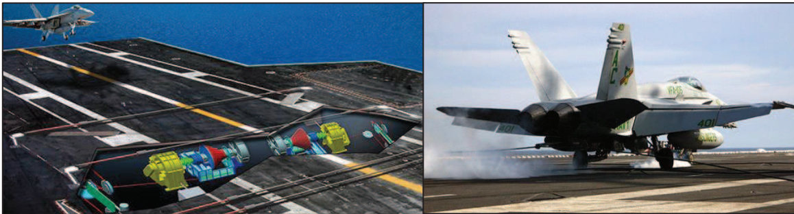
Figur 39: Illustrasjon av et energi absorberende system benyttet til å ta opp den kinetiske energien til jagerfly. [I.26]
