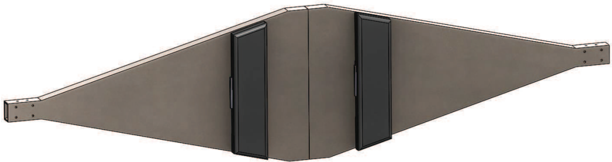
Figur 103: Friksjons elementer montert til bjelken.
