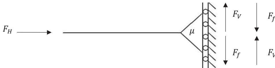
Figur 45: Forenkling av fender med virkende krefter.
