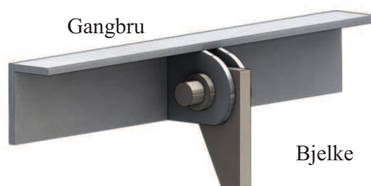
Figur 115: Illustrasjon av bolt forbindelse mellom gangbru og bjelke aluminium braketter 9mm og titan braketten er 20mm.
