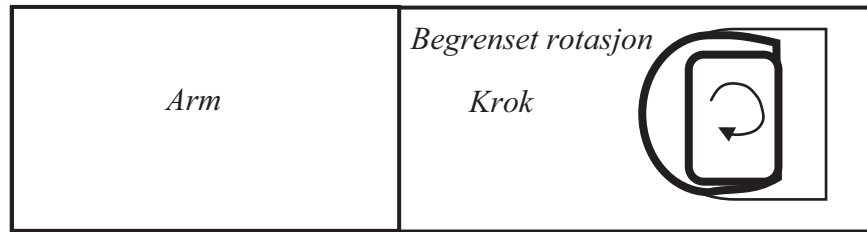
Figur 85: Illustrasjon av endret opplager tillater begrenset rotasjon om y-aksen.
