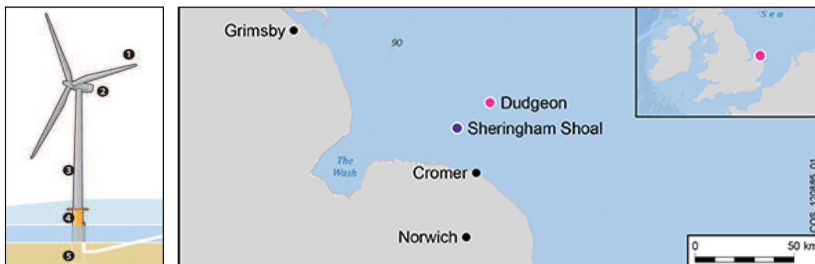
Figur 3: (t.v.) Illustrasjon av en offshore vindturbin.1: Rotor 2: Nav 3: Tårn 4: Kobling til tårn samt. Overgangssone 5: Fundament.[I.5] Og (t.h.) geografisk lokasjon til Sheringham Shoal og det fremtidige Dudgeon prosjektet til Statoil.[I.6]
