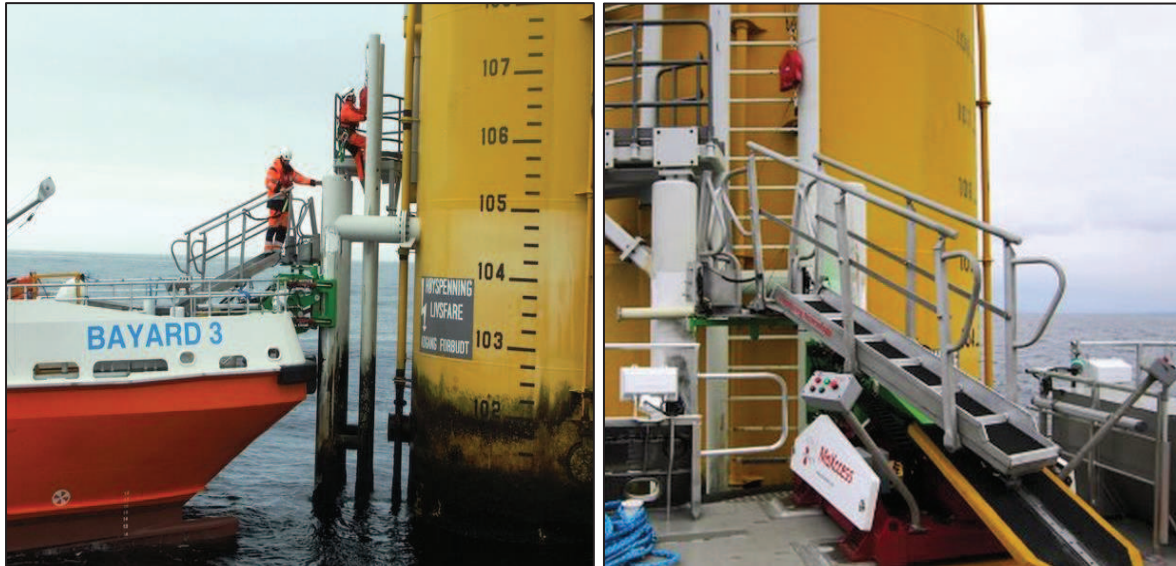
Figur 37: Illustrasjon av et fendersystem levert av SH Hydraulik til bruk på Bayard 3, et service fartøy, nå under eierskap av Fred Olsen windcarrier AS. [I.22]
