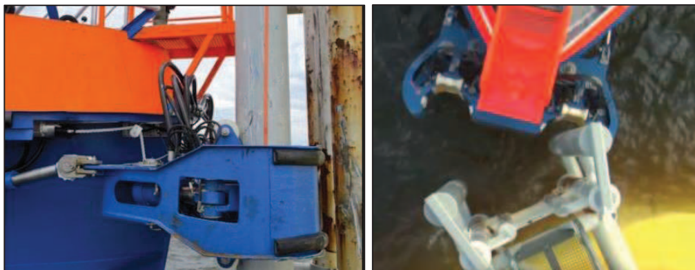
Figur 36: Illustrasjon av en eksisterende fenderløsning. Hydraulisk «klo» som griper om stålrørene på vind turbinen.[I.21]
