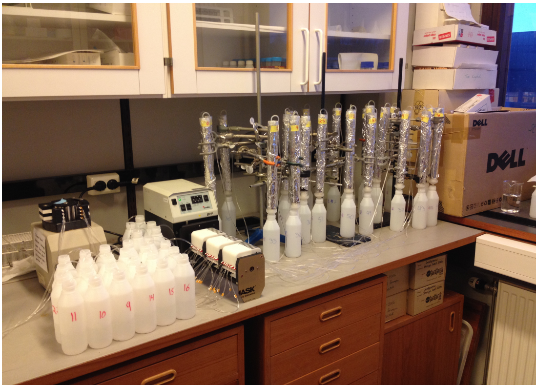
Figur 25: Forsøksoppsett med søylene koblet til en pumpe som pumpet ekstraksjonsvæsken fra flaskene til venstre gjennom slangene og ned i søylen. Flaskene under søylene tok i mot utvasket væske.
