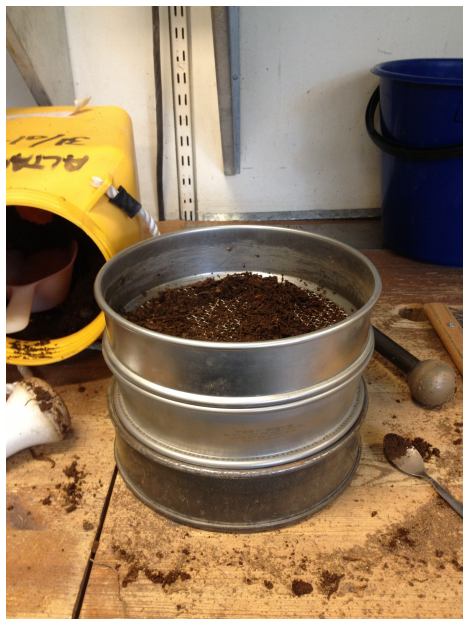
Figur 21: Sikteutstyr for sikting av jord
