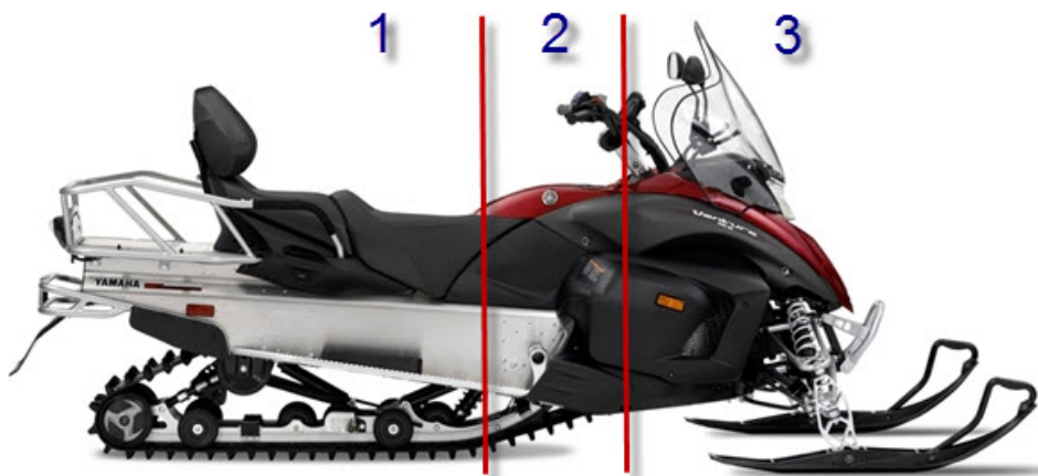
Figur 50: Oppdeling av plasseringsområder for batteripakker (42)
