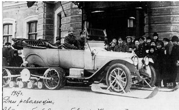
Figur 14: Modifisert Twin-6 med belter bak og ski foran (3)
