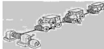
Senere: Ford brukte et langt tau og dro bilene rundt i fabrikk, slik at arbeiderne kunne stå stille
