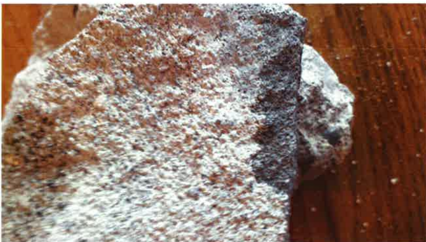
Figur 14: Sementholdig mørtel i ytre sjikt
