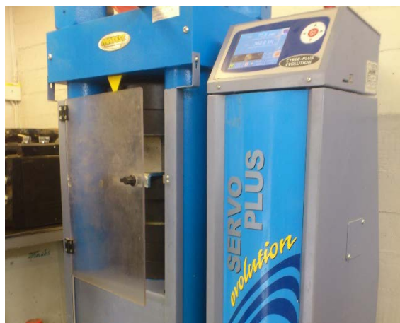
Figur 24 Trykkprøving av terning.
