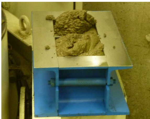
Figur 23 Prøveformene fylles med fersk fugebetong.
