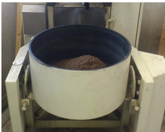
Figur 21 Tørrblanding av delmaterialer.
