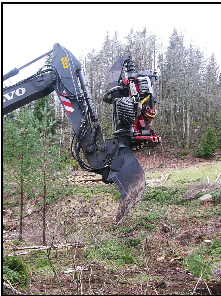
Bilde 9. «Log Max 7000 XT» hogstaggregat ved forflytting (foto: Tim-Oliver Wenski)
