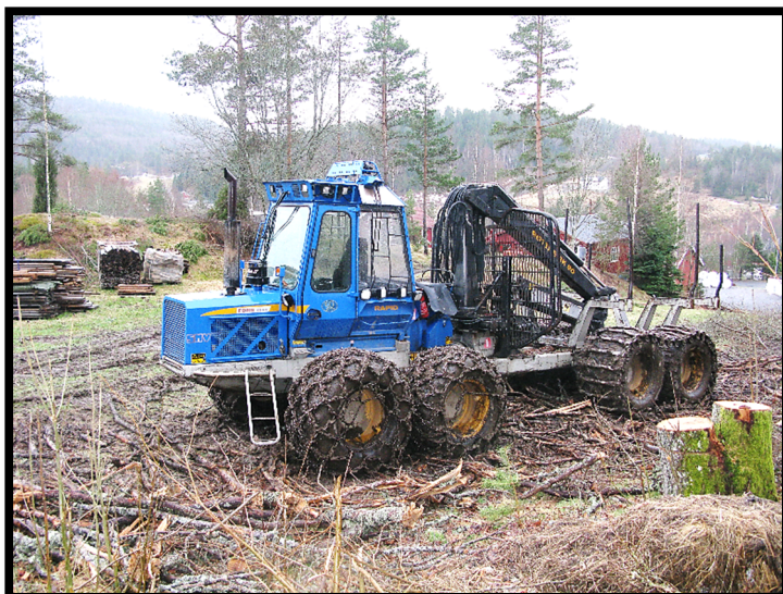
Bilde 8. Lassbærer «Rottne SMV Rapid» (foto: Tim-Oliver Wenski)
