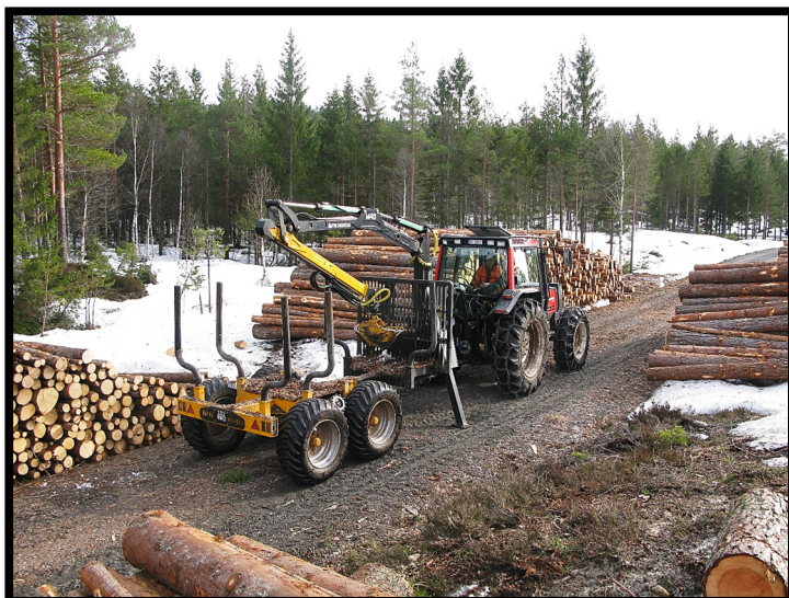
Bilde 11. «Valtra Valmet 6400» traktor og «FTG Moheda M101/ 4WD» tømmervogn (foto: Tim-Oliver Wenski)
