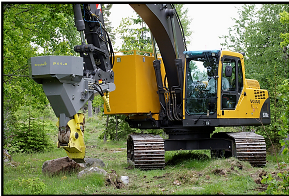
Bilde 6. Beltegående gravemaskin utstyrt med plantemaskinen «Bracke Planter P11.a» ( brackeforest.com )
