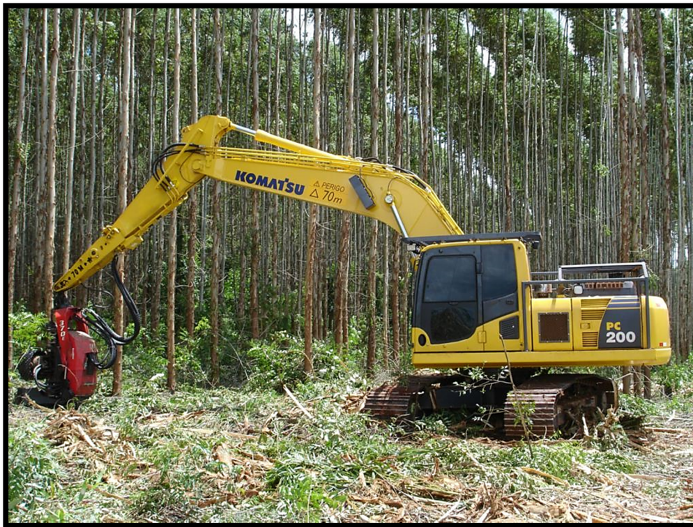
Bilde 4. Den beltegående gravemaskinen «Komatsu PC200F-8» med fabrikkmontert «hogstaggregat-pakke» (komatsuforest.cz)
