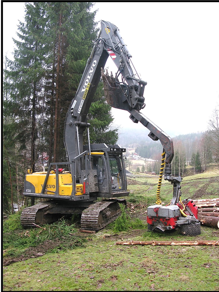
Bilde 7. Gravemaskin «Volvo FC2121C» utstyrt med et «Log Max 7000 XT» hogstaggregat (foto: Tim-Oliver Wenski)
