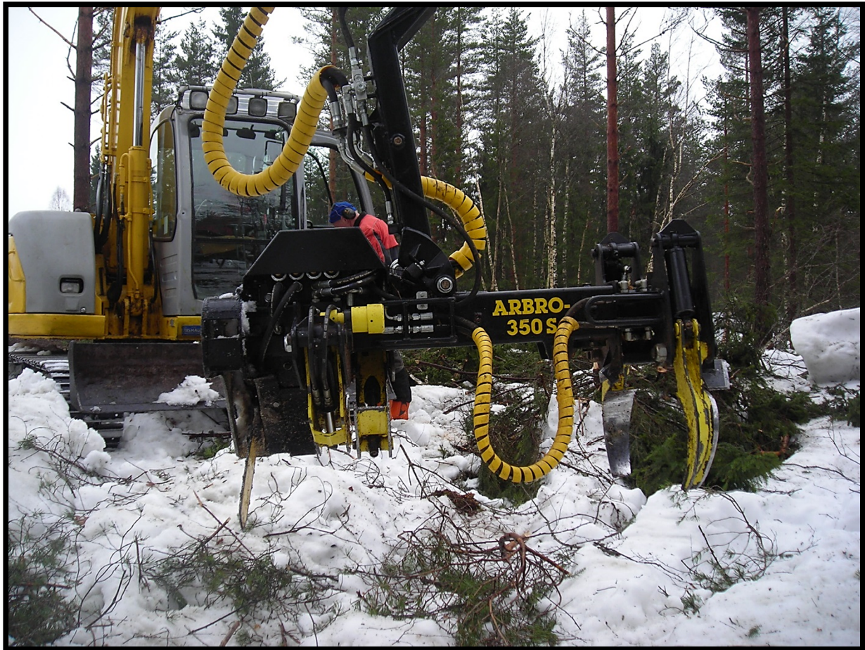
Bilde 12. «Arbro-350 S» hogstaggregat (foto: Tim-Oliver Wenski)
