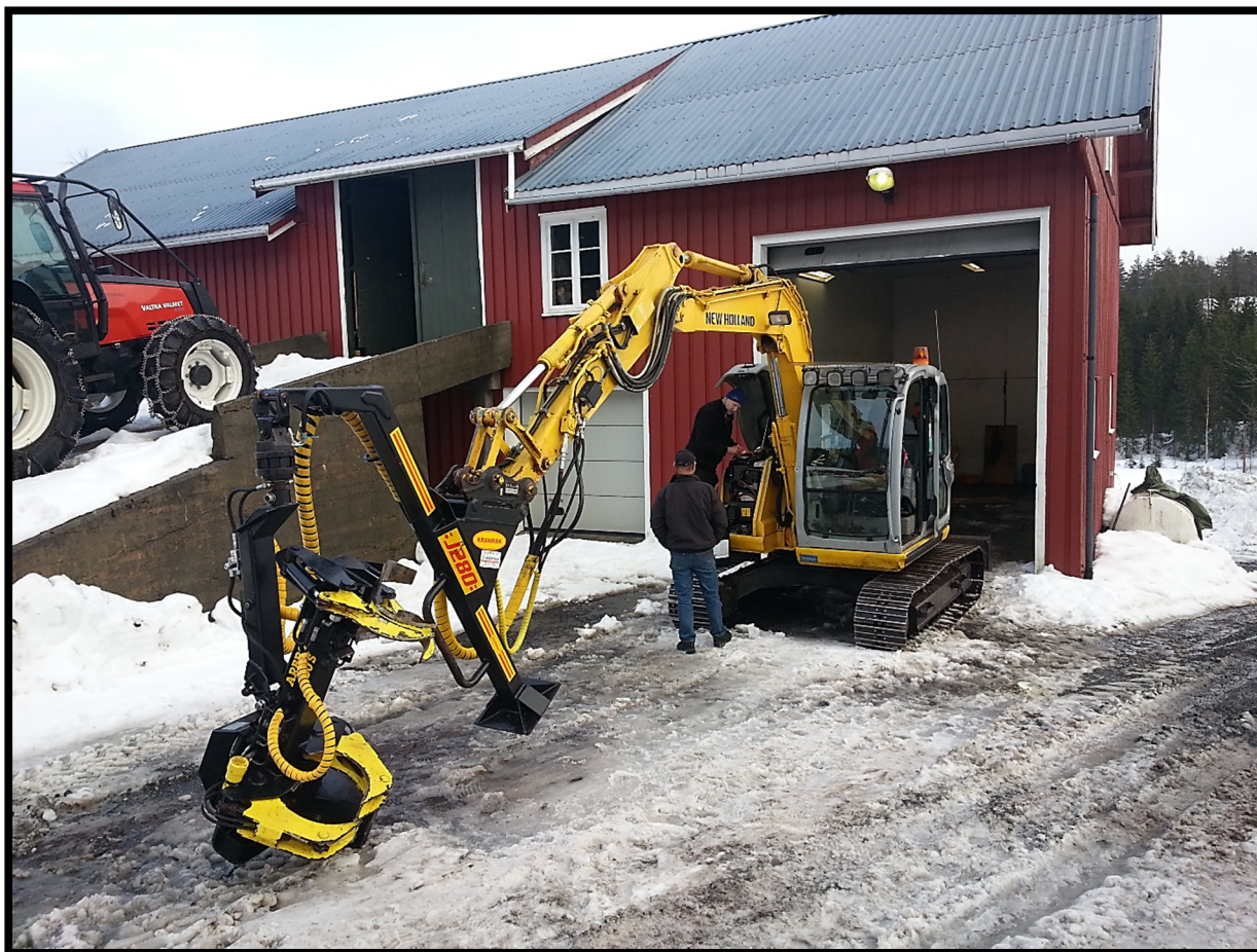
Bilde 10. Gravemaskin «New Holland Kobelco E70SR» utstyrt med et «Arbro-350 S» hogstaggregat (foto: Tim-Oliver Wenski)
