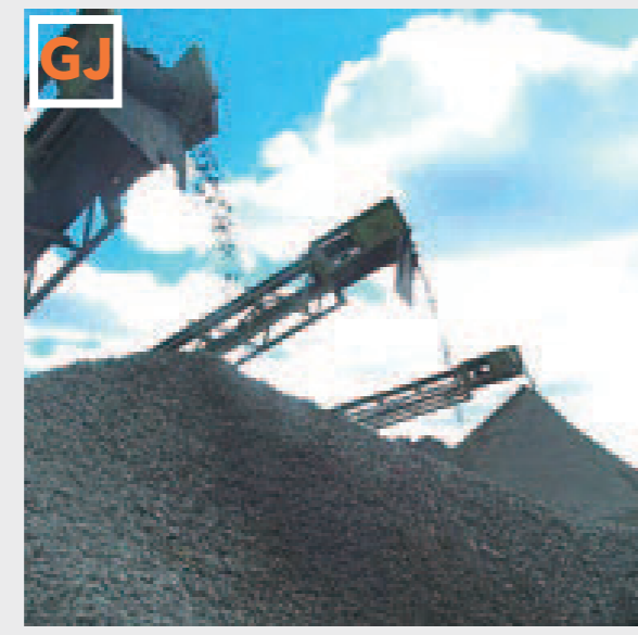
Gjenvinning Knutst betong kan gjenvinnes og brukes i veioppbygning, grøfter, og som tilslag i ny betong. Veileder utarbeidet av Statsbygg: GJENBRUK OG RESIRKULERING AV MASSER PÅ FORNEBU 2003 http://www.arkitektur.no/?nid=155923&pid0=155001 http://www.statsbygg.no/FilSystem/files/prosjekter/fornebu2/temamasser/massehandtering.pdf
