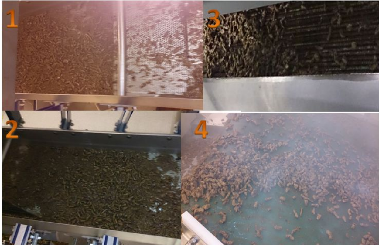
Figur 4.1.2.3: Illustrasjon av oppsamling av marinaderester etter ProWok. Figuren viser hvordan oppsamling av marinaderester kan føre til at kjøttet blir liggende for tett på transport bånd, og derfor ikke blir tilstrekkelig varmebehandlet. 1) Hullristen som skal skille ut marinaderestene og annet ”grums” etter ProWoken slipper for mye forbi, det samler seg derfor opp på andre siden, og kjøttet setter seg fast i det. 2) Mye kjøtt ligger her stille i ”grumset” fra marinaden istedet for å transporteres videre til dampovn i jevnflyt. Når kjøttet på båndet får nok samlet masse vil det bevege seg videre, og legge seg som en stor haug på transportbåndet gjennom dampovn. 3) Transportbåndet gjennom dampovn. Her ser en at det har landet en haug med kjøtt på den bortre delen av båndet, mens delen av båndet nærmest er nesten tom for kjøtt. 4) Transportbånd mellom dampovn og fryser. En kan her observere at hauger med kjøtt som går inn i dampovn, kommer også ut på samme måte. (Foto; F. Holt).
