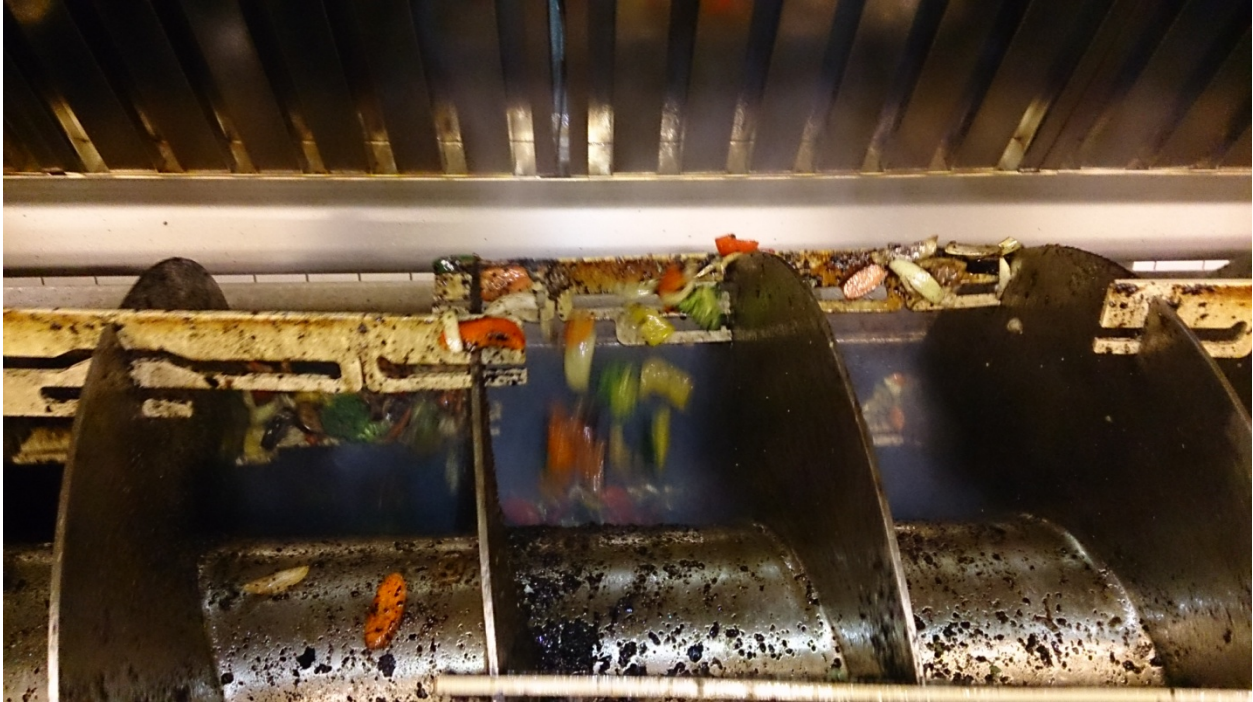
Figur 3.4: Steking av grønnsaker i ProWok. Fotografiet viser transport av wokmix med grønnsaker gjennom ProWoken. Skruen beveger seg rundt med en hastighet som er forhåndsprogrammert. Plastikkskraper langs skruen transporterer grønnsakene fra den varme oljen og opp langs veggene i woken, og ned i neste rom i skruen. (Foto; F. Holt).
