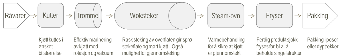
Figur 1.2: Flytskjema over ProWok prosesslinje fra råvarer til ferdig pakket produkt. De ulike boksene representerer de viktigste enhetsoperasjonene i produksjonen av marinert pepperbiff (Figur fra Fortrolig informasjon 1).
