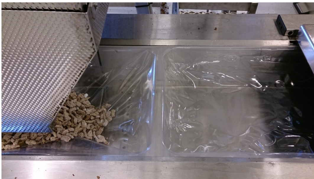
Figur 2.1.10: Fotografi av plastikkfilmen som har blitt smeltet og formet i dyptrekkeren. Til venstre i fotografiet kan en se den delen av vekten som tømmer oppveid mengde råvare ned i plastfilmen, før videre sammensmelting med øvre lag plast. (Foto; F. Holt)
