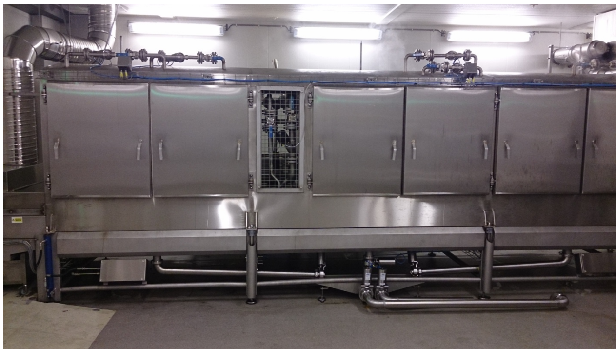
Figur 2.1.6: BCH Linear Oven. Fotografi av dampovnen på ProWok linjen. Produkt kommer inn fra ProWok på høyre side, går gjennom ovnen på et transport bånd av stål, og videre ut av ovnen på venstre side. Dørene kan åpnes ved hjelp av tilhørende kontrollpanel på veggen. (Foto; F. Holt)
