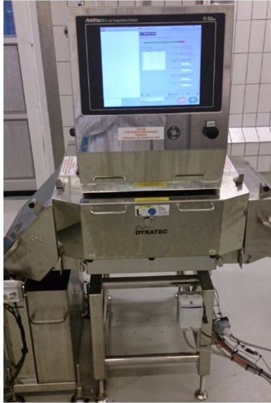
Figur 2.1.8: Fotografi av røntgenmaskinen fra ProWoklinjen på Råbekken. Her vil kjøttet transporteres fra fryser og inn i røntgenmaskinen på høyre side. På skjermen kan en følge alt som går gjennom, og det tages foto av uønskede objekter. De uønskede objektene kastes ut i en beholder plassert nede på venstre side av maskinen. Kjøtt som er ok vil komme ut av maskinen på venstre side, og fortsette videre til oppsamlingstank før det veies og pakkes. (Foto; F. Holt)
