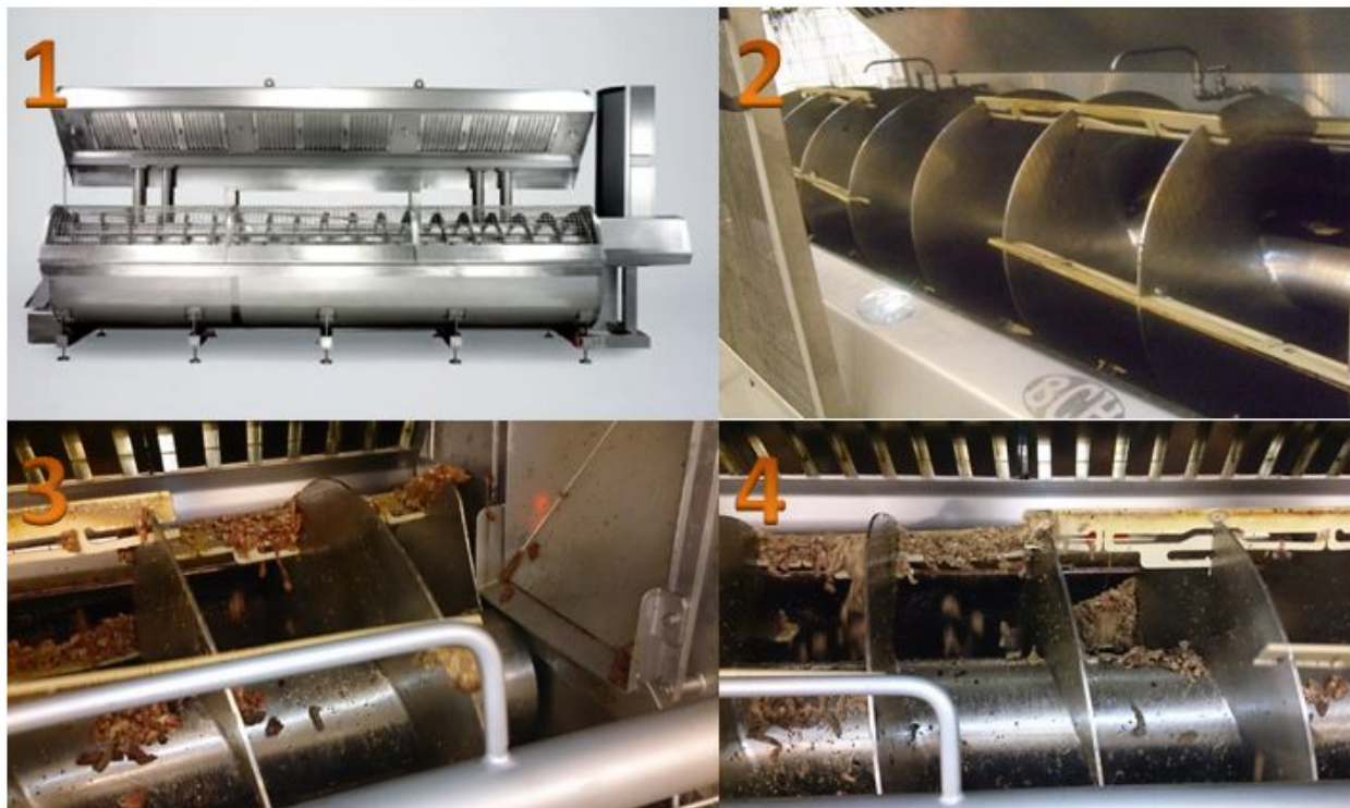
Figur 2.1.5: Illustrasjon av ProWok, før og under produksjon. 1) Fotografi av hele maskinen før produksjon. 2) Nærbilde av transportskruen. En kan her se dysene over, som tilfører rapsolje og plastskrapene som frakter kjøttet langs veggen på woken. 3) Starten av woken, der rått kjøtt kommer inn. 4) Ferdig ”brunet”-kjøtt. En kan se at bitene er kommet bedre fra hverandre, og sitter ikke lenger like sammenklistret. (Foto; 1 & 2 Fortrolig informasjon 1, Foto; 3 & 4 F. Holt).
