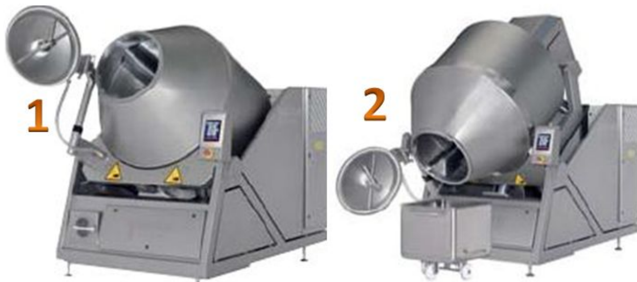
Figur 2.1.4: Illustrasjon av Günther GPS1250 K-H tromler. Figuren viser ved fotografi 1 en trommel i oppfyllingsposisjon, og fotografi 2 i uttømmingsposisjon (Foto; Günther (2014)).
