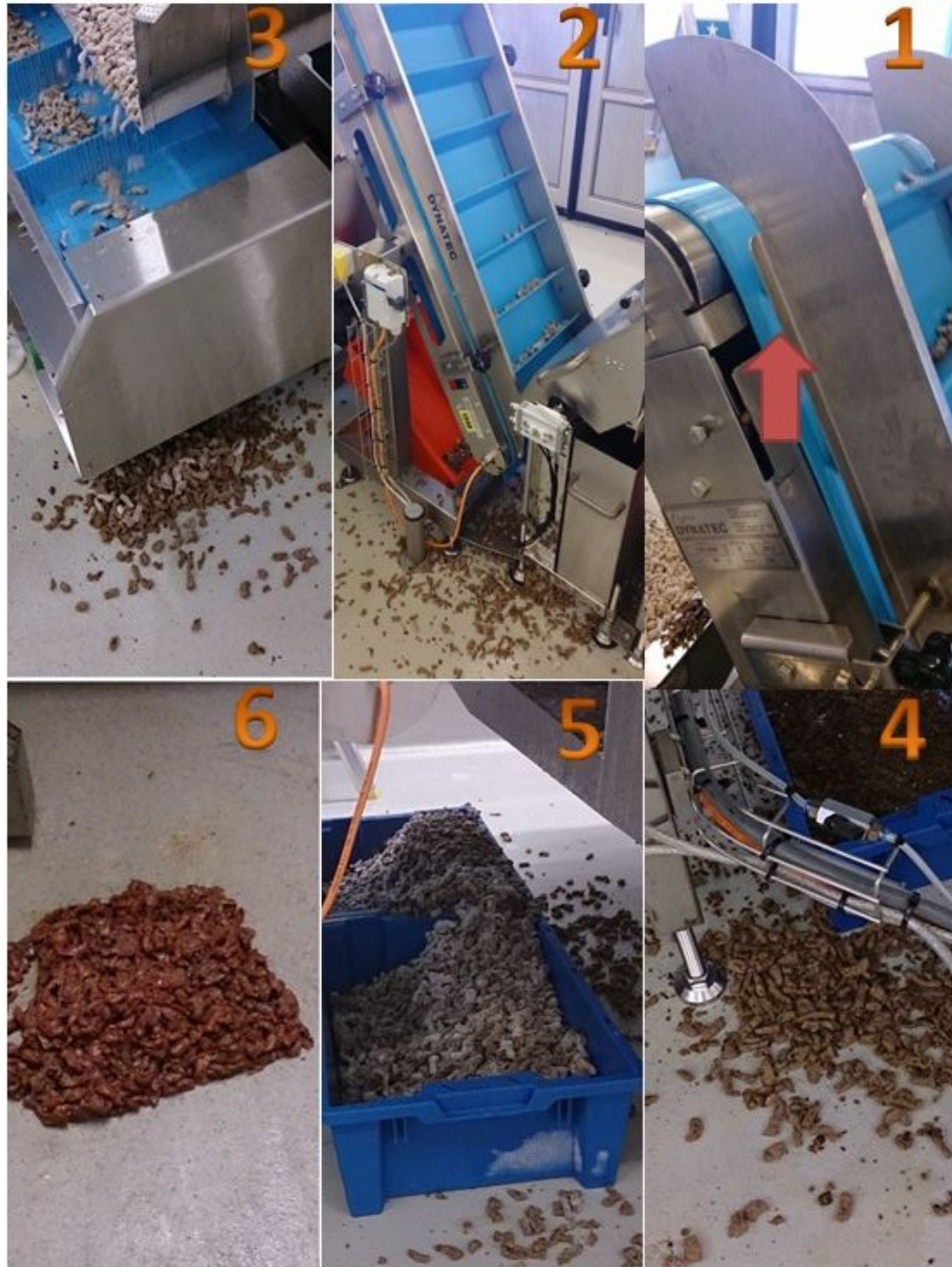
Figur 4.1.2.2: Illustrasjon av synlig svinn på ulike steder i produksjonen. 1) Transportbånd mellom røntgenmaskin og buffertank er ikke satt opp korrekt, pilen viser en glipp på omlag en cm som kjøttet kan falle gjennom. 2) Kjøtt har falt på gulvet foran røntgenmaskin på grunn av glippen fra bilde 1. 3) Kjøtt faller på gulvet ved flytting fra buffertank til transportbånd før vekt. 4) Kjøtt som har falt på gulvet foran røntgenmaskin. 5) Her har klumper med kjøtt satt seg fast ved inngang til røntgenmaskin. Båndet mellom fryser og røntgenmaskin har derfor fylt seg opp, og kjøttet faller på gulvet (eller i blåbakker) etter fryser. 6) Kjøtt som har falt på gulvet ved manuell mating til ProWok etter marinering i vakuumentromler. (Foto; F. Holt).
