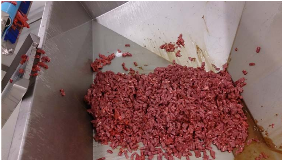
Figur 2.1.3: Kutting av kjøtt, samt tilsetning av ingredienser til marinade i marineringstank. Figuren viser marineringstank, der oppkuttet kjøtt blandes med salt, krydder, vann og olje. Råvarene blir gradvis sugd opp i trommel med vakuuim. For å forhindre at noe klumper seg i bunn, blir salt blandet godt inn med kjøttet (Foto; F. Holt).
