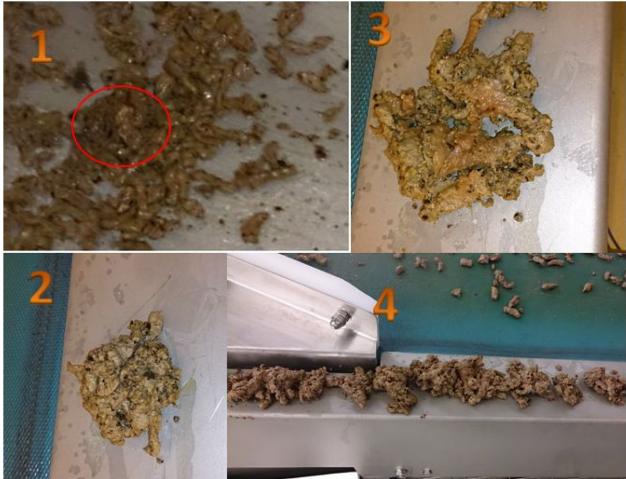
Figur 4.1.2.1: Illustrasjon av klumpdannelse på ProWok linjen. Fotografiene viser klumpdannelser som kan oppstå dersom ProWoken ikke har klart å løse opp kjøttet godt nok. Slike klumper følger hele veien fra ProWoken og til røntgenmaskinen, der de gjerne setter seg fast på vei inn. 1) Her kommer kjøttet ut av ProWok, og skal transporteres videre til dampovn. I en røde sirkelen observeres en klump med kjøtt som ikke har blitt separert ordentlig i ProWoken. 2) Denne klumpen med kjøtt er plukket ut før den har kommet inn i fryseren (den er altså ferdig varmebehandlet). 3) Her er den samme klumpen som i bilde 2), en ser at kjøttet i midten fortsatt er ”rått”. 4) Flere slike klumper har blitt plukket ut av denne produksjonen. (Foto; F. Holt).
