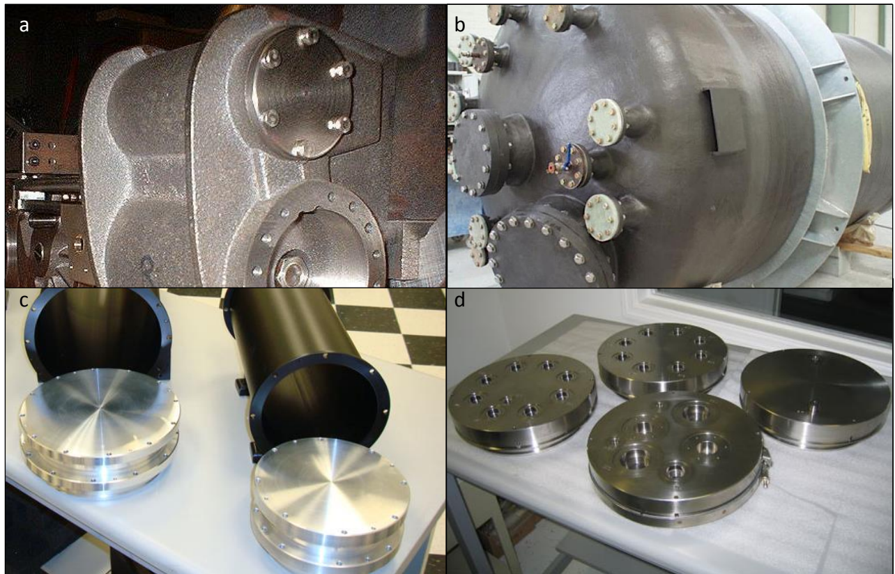
Figur 2.2: Eksempel på bruksområder for runde flate lokk: (a) Endelokk på sylindere til et eldre lokomotiv [19], (b) Trykketank med lokk i flere størrelser [20], (c) Undervannsrør med tilhørende lokk [13], (d) Lokk til forskjellige undervannsrørsystemer [13]
