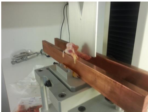
Figur 10: Knekktesten ble gjort med et apparat som satt trykk på benet med en plate. Trykket ble målt helt til benet knakk. (bilde: Privat)
