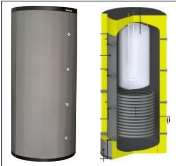
Figur 2.10. CAS-BS 801. Akkumulatortank med innebygget varmtvannsbereder, elektrisk kolbe, varmeveksler for solvarme og tilkoblingsmuligheter for annen varmekilde (Bye, 2014).
