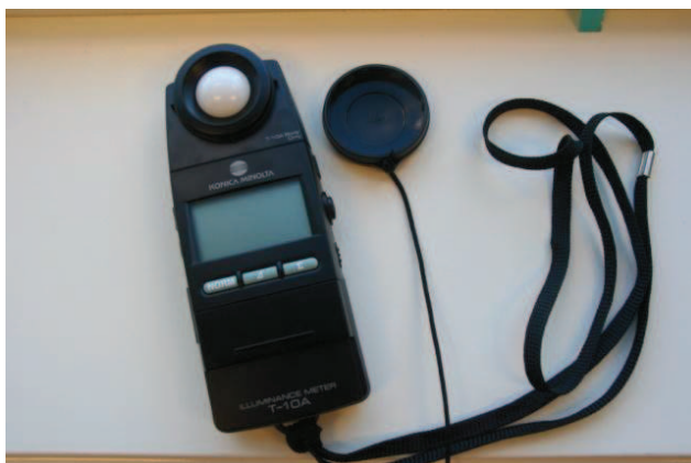
Figur 3.4.1 måleinstrument Konica Minolta Illuminance meter T-10A (body only)
