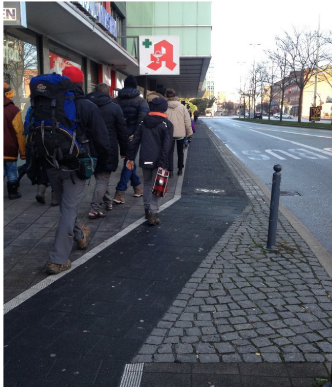
Tyskland Kiel. Sykkelvei med fortau «Cykelsti», kun adskilt fra veien med tre rader brostein. Tross smale fortau og mange fotgjengere, respekterer disse at de skal bruke sin side av fortauet. Foto: Kristine Sand
