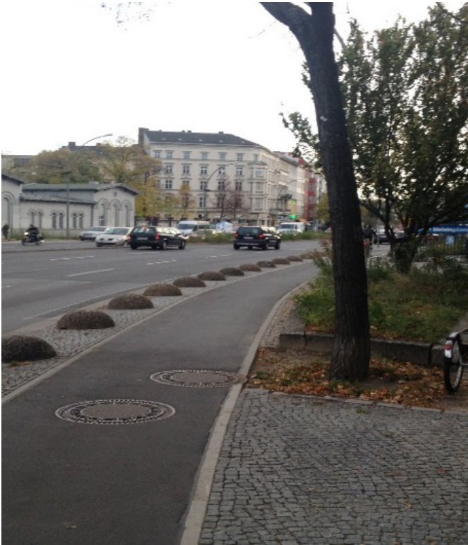
Sykkelvei med fortau i Berlin, adskilt fra veien med betongdumper for å gi sykklistene ekstra trygghet. Foto: Kristine Sand
