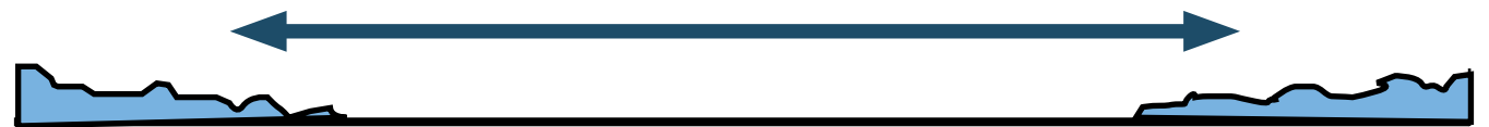
Figur 24. Snøen brøytes ut mot kanten og blir ofte liggende i sykkelfeltet. Inspirert av (Sanders 2013).
