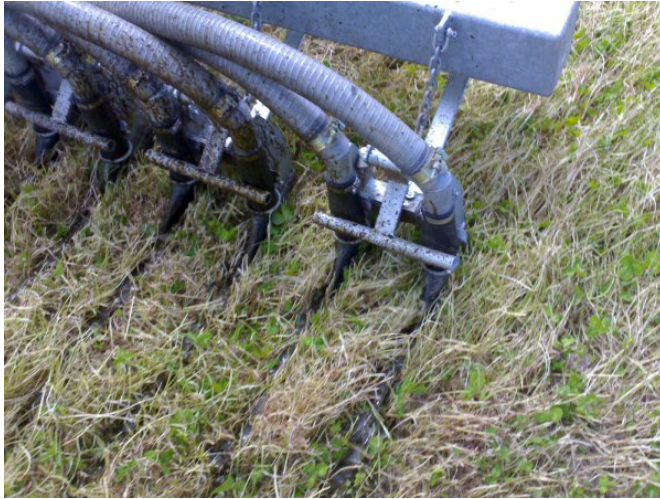
Figur 20: Nedfelling. Nærbilete av slepesko som legg gjødsla i striper ned i bakken.
