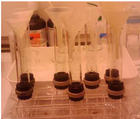
Figur 13: Vann og fiskeprøver ble filtrert gjennom et Whitman analytisk filterpapir over i deponeringsrør (Foto Skipperud 2008).
