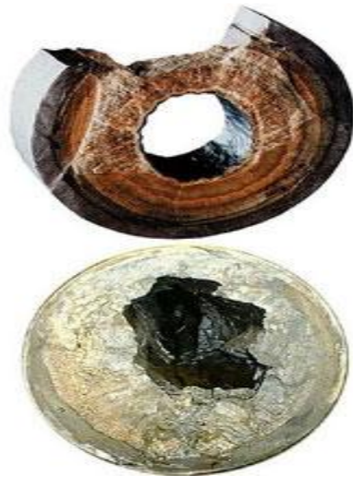
Figur 1: Produksjonsrør fylt av scaleavleiring (Statoil 2008).
