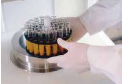
Figur 16: Teflonrør som plasseres inn i kammeret til ultraclaven (Borowski & Schoenfield 2006).
