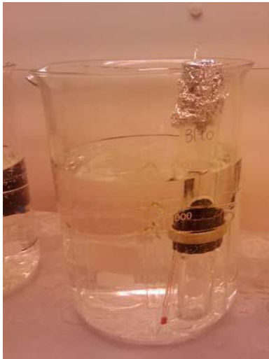
Figur 14: Termisk deponering av ^{208}\text{Po} ble utført i ett 90^\circ\text{C} vannbad i 3 timer (Foto: Skipperud 2008).
