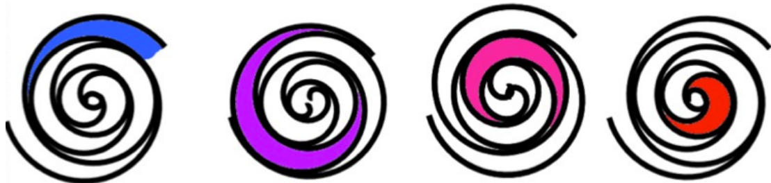
figur 2.3.1-1 viser virkemåten til en scroll kompressor/ekspander, [5]
