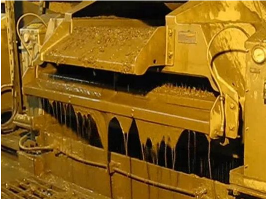
Figur 3: Tradisjonell "shale shaker" i operasjon (Cubility 2012).
