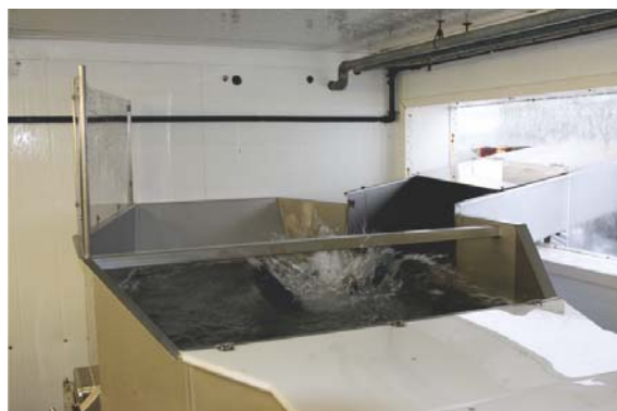
Figur 23. Ensretterkaret som mottar fisk fra slaktemerden via vannavskiller (Figur 22). De tre ensretterkanalene tildekket med lokk, som sees i forkant av bildet.
