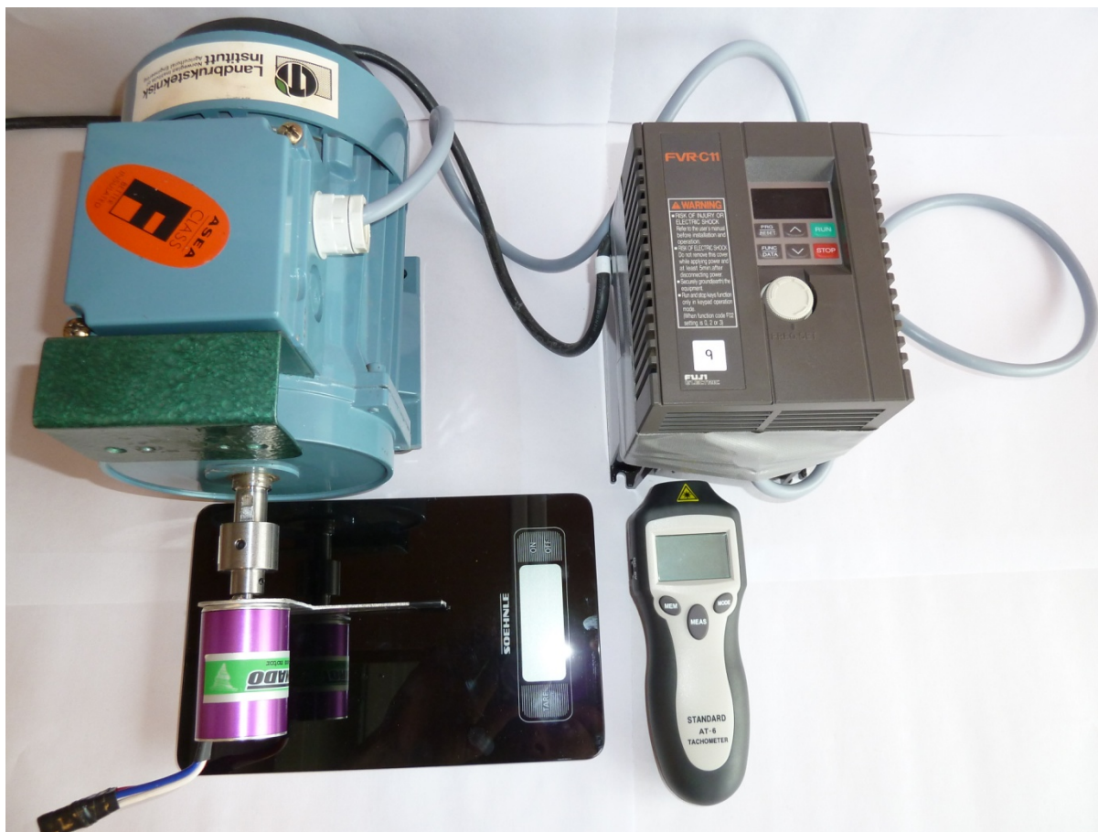
Figur 26: Første test av Tornado, børsteløs 3 fase motor/generator.
