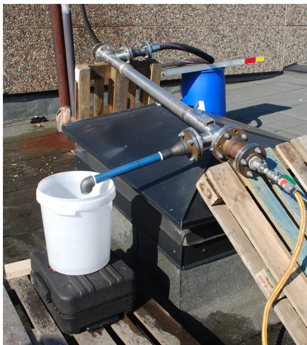
Figur 41 Oppsett kondensering av damp fra kondensattank.
