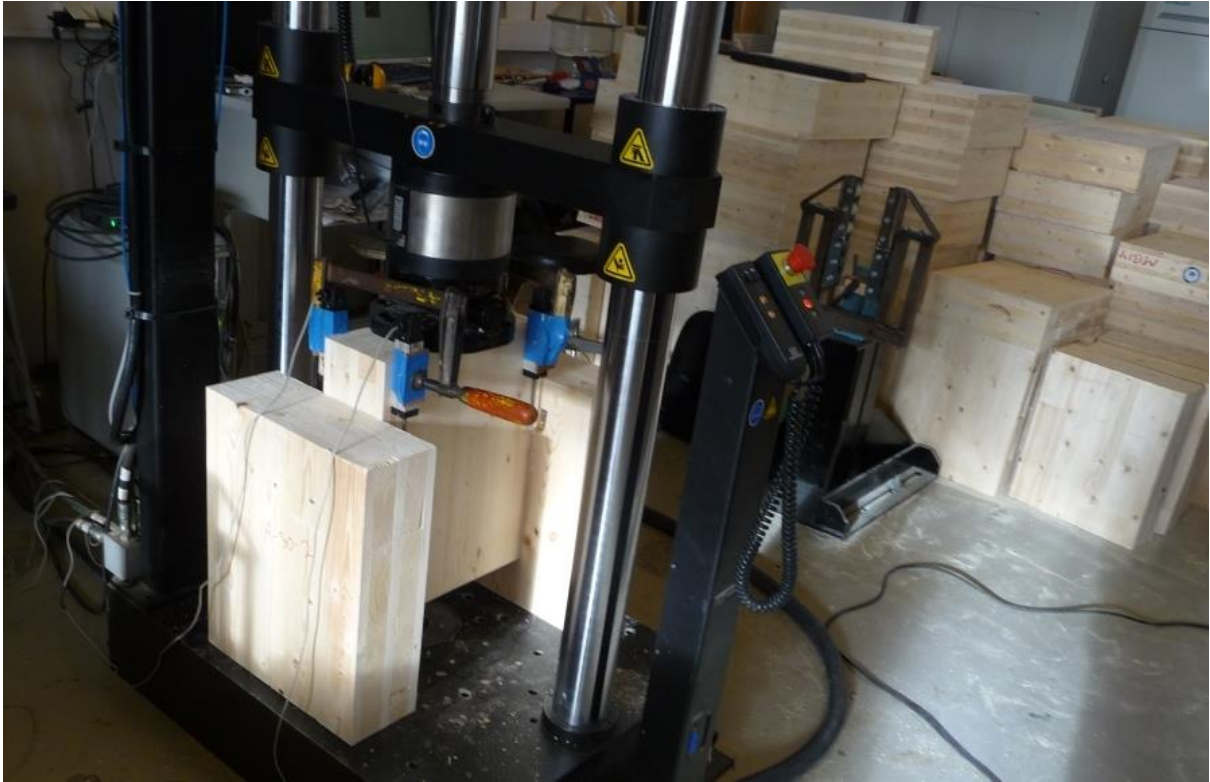
Figur 12: Bilde av prøve A-30-2, klar til å starte nedtrykking
