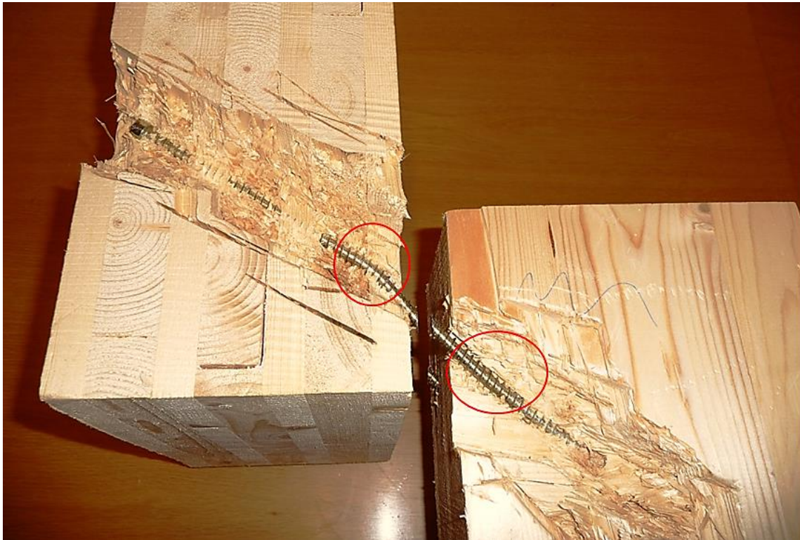
Figur 20: Hele skruen eksponert etter brudd i prøve nr B-30-2. Tredelen til venstre er sidepanelet. Et tydelig flytledd har oppstått, markert med den røde ringen til venstre. Delen av skruen i midtpanelet til høyre i bildet har også plastisk deformasjon, men uten det markante leddet, siden fiberretningen der er «vannrett».
