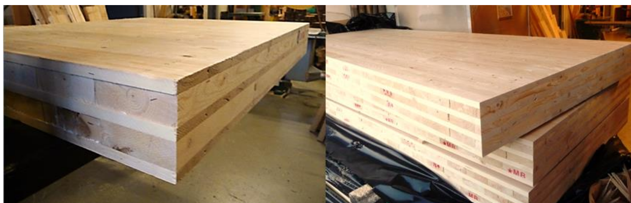
Figur 9: Til venstre: massivtreelement type A (145 mm). Til høyre: massivtreelement type B (170 mm)
