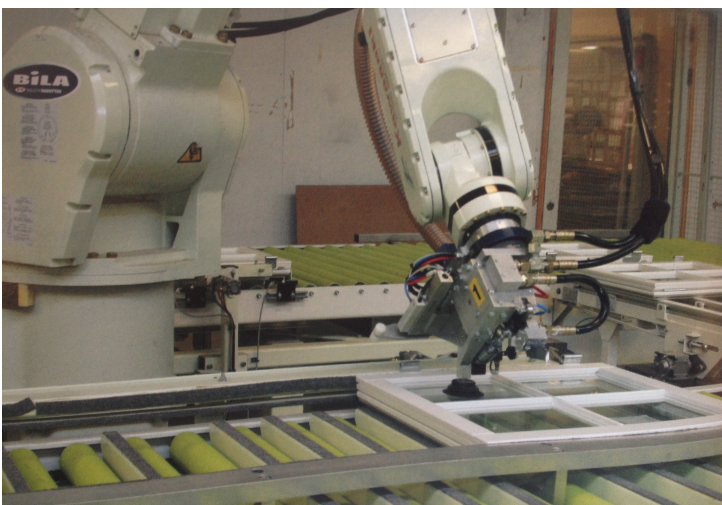
FIGUR 16. BRUK AV ROBOT VED PRODUKSJON AV PREFABRIKASJON (Beim et al. 2009 s. 62).
