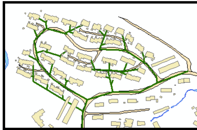
Figur 4-1 Det optimale avløpsfelt. Et homogent avløpsfelt beliggende på Brøttet, nordvest i Muusøya rensedistrikt. Vei og bygninger i beige, blå viser bekk e.l. Ledninger i grønt er av type separatsystem.
