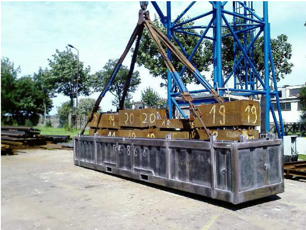
Figur 5-18: Fire- punktløft av prototype [12].
