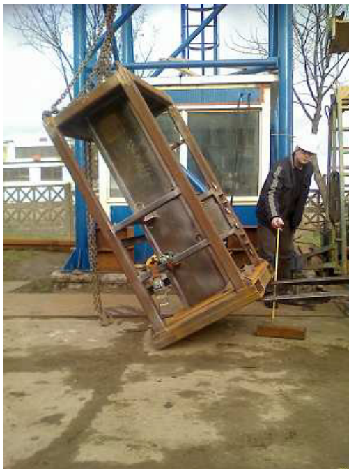
Figur 5-22: Tilting test av prototype[12].
