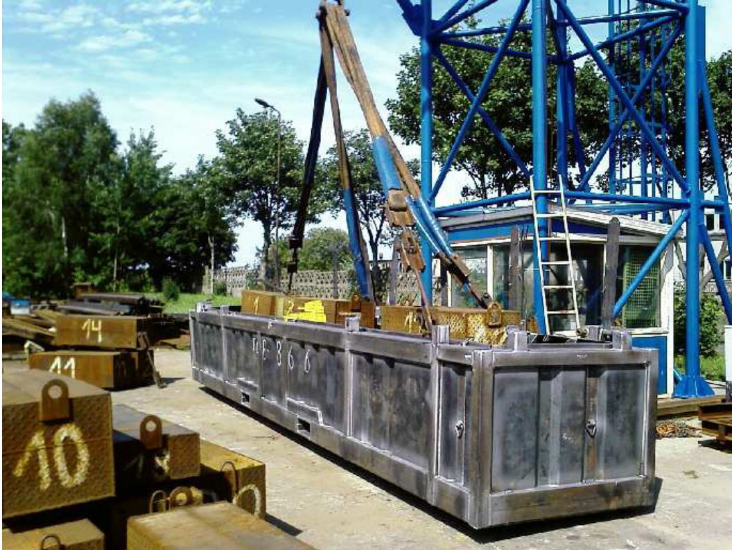
Figur 5-19: Diagonal- punktløft av prototype [12].
