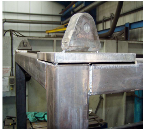
Figur 3-15: Sveis mellom støtteplate og profil [9].
