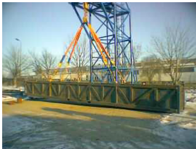
Figur 5-20: Droptest av prototype [12].
