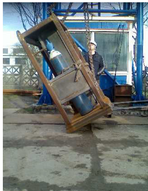
Figur 5-22: Tilting test av prototype[12].
