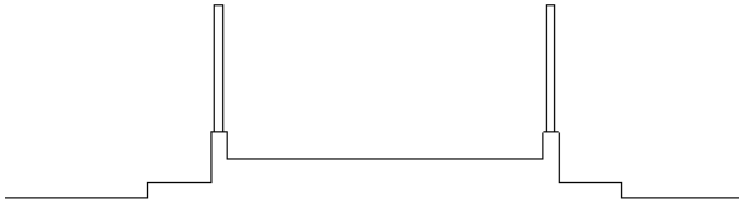
Figur 14 Snittegning av fôrbrett. Illustrerer oppkant med målene 10 x 40 cm på begge sider av fôrbrettet
