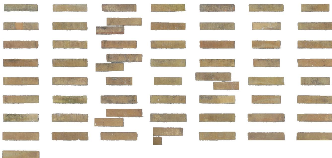
Figur 4.42: Det er tydeleg fleire par med steinar som ikkje har klart å skilje seg frå kvarandre og det kan tyde på at programvaren ikkje likar stor variasjon på mursteinen.
