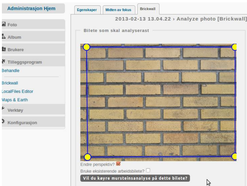
Figur 4.2: Utsnitt av starten av mursteinsanalysen, dei gule sirklane kan ein nytte for å kalibrere bilete til å vera tilnærma normalt på synsvinkelen. Den nye ramme i blått verdt så dratt ut til å romme heile bilete. Det er difor viktig å prøve å få ramma til å gå beint med mursteinen og fugene som ein kan sjå i døme ovanfor. Dei blå strekane følgjer parallelt med fugene til venstre og både i øvre og nedre kant.
