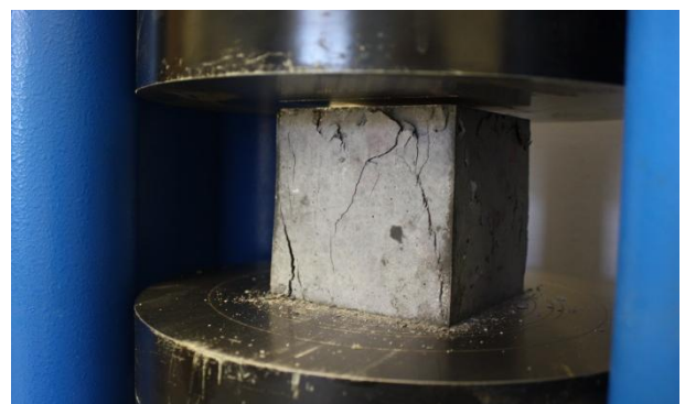
Figur 15: Typisk brotform etter trykktesting [40].
