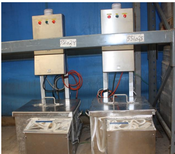
Figur 19: Temperaturstyrte herdekar får V-teknikk [40].
