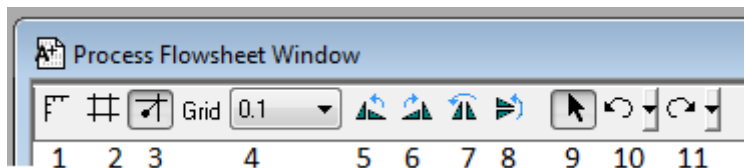
Figur 8. Skjermbilde fra Aspen Plus. I øvre venstre hjørne av flytskjemaet, har man en del alternativer for utseende på flytskjemaet. Fra venstre: 1) knapp for størrelsesangivelse langs ytterkantene. 2) knapp for å vise rutenett i flytskjema. 3) knapp for at strømningslinjer og utstyr skal legge seg i rutenettet automatisk. 4) oppløsningen på rutenettet. 5 – 8) endrer orienteringen på utstyret i flytskjemaet. 9) gjør at man får musepeker i flytskjemaet som kan flytte på utstyr og strømningslinjer. Denne knappen kan brukes etter at man har satt inn utstyr eller strømningslinjer, slik at man kommer ut av modus for å sette inn ting. Man kan også trykke på «esc»-tast. 10-11) Gå bakover eller evt. framover i endringer i flytskjemaet.
