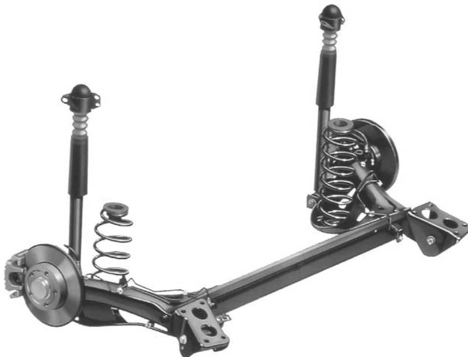
Figur 33 Semi-stiv bakaksel brukt i VAG gruppen [2]
