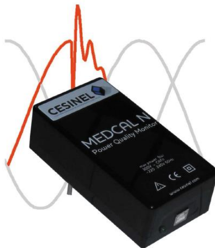
Figur 3.2 viser nettanalysatoren Medcal N som ble benyttet ved måling og logging av spenningskvalitetsparametere ved Energilaboratoriet ved UMB. [45]
