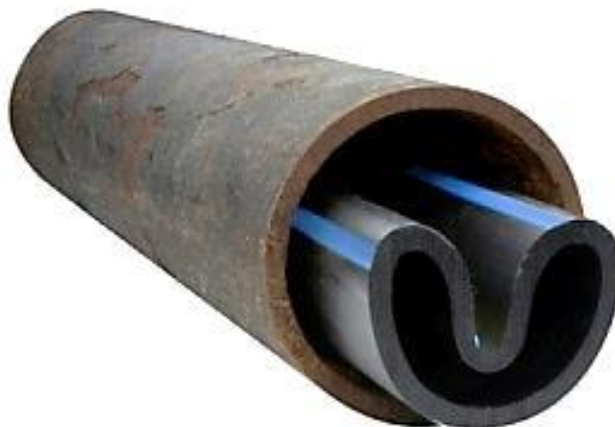
Figur 16 Illustrasjon på hvordan et tetttilsluttende rør ligger i røret under installasjon, før oppvarming og utbretting (Scandinavia VA-Teknik AB)
