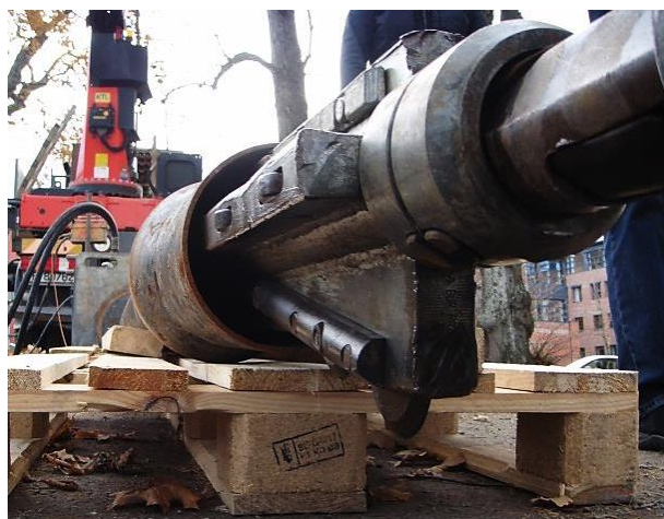
Figur 12 a og b Eksempel på kuttehode til bruk ved utblokking av støpejernsrør
