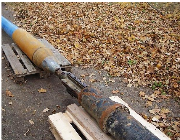
Figur 12 a og b Eksempel på kuttehode til bruk ved utblokking av støpejernsrør
