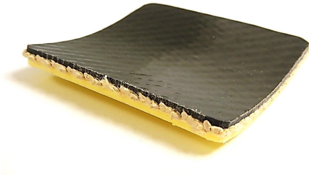
Figur 5 Utsnitt av en Primus Line® Gas. Slangen består av et vevd kevlarnett med et lag PE på hver side. Den gule kappen (under) viser at den er beregnet for re-lining av gassledninger
