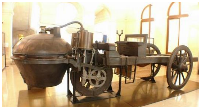
Figur 12 . Viser dampdrevet kjøretøy med dobbel sylinder med motsatt bevegelse på stemplene[18].
