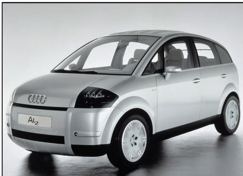
Figur 26. Viser aluminiums bil Audi A2 [23].
