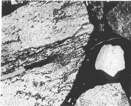
Foto nr 11 Bildet viser en reagert mylonitt i tynnslip D. 2 typer reaksjonsprodukter finnes, brune inne i partiklen og fargeløs gel i overgangen til pastaen. Bildet størrelse er 0,8mm x 1,2mm
