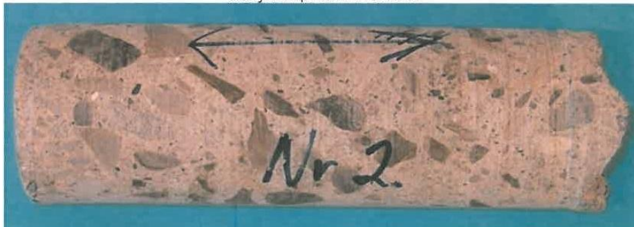
Foto nr 4. Oversiktsfoto av borkjerne Nr 2. Overflaten til venstre på bildet.
