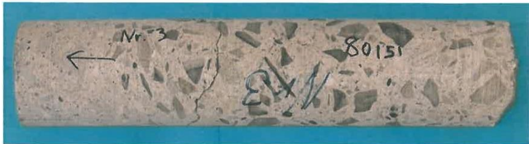
Foto nr 7. Oversiktsfoto av borkjerne Nr 3. Overflaten til venstre på bildet.
