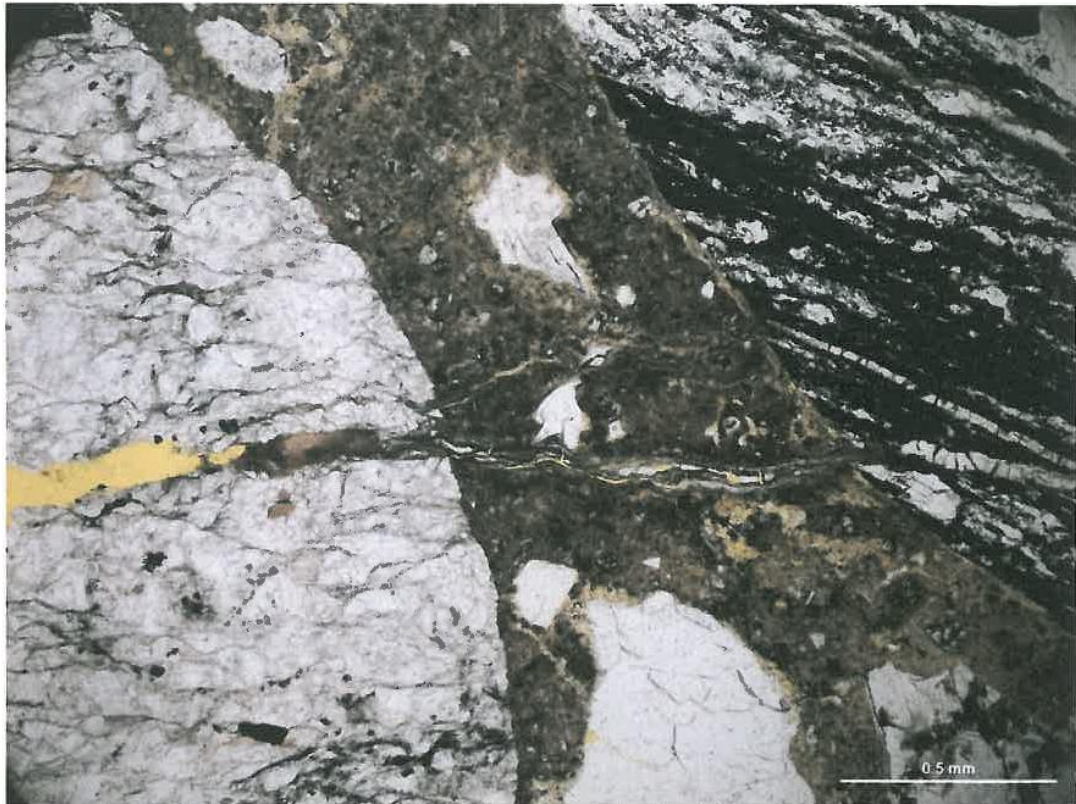
Foto nr 21. Tynnslipet fra kjerne Nr 1. Bildet viser alkaligel i riss mellom gråvåkke og fyllitt.
