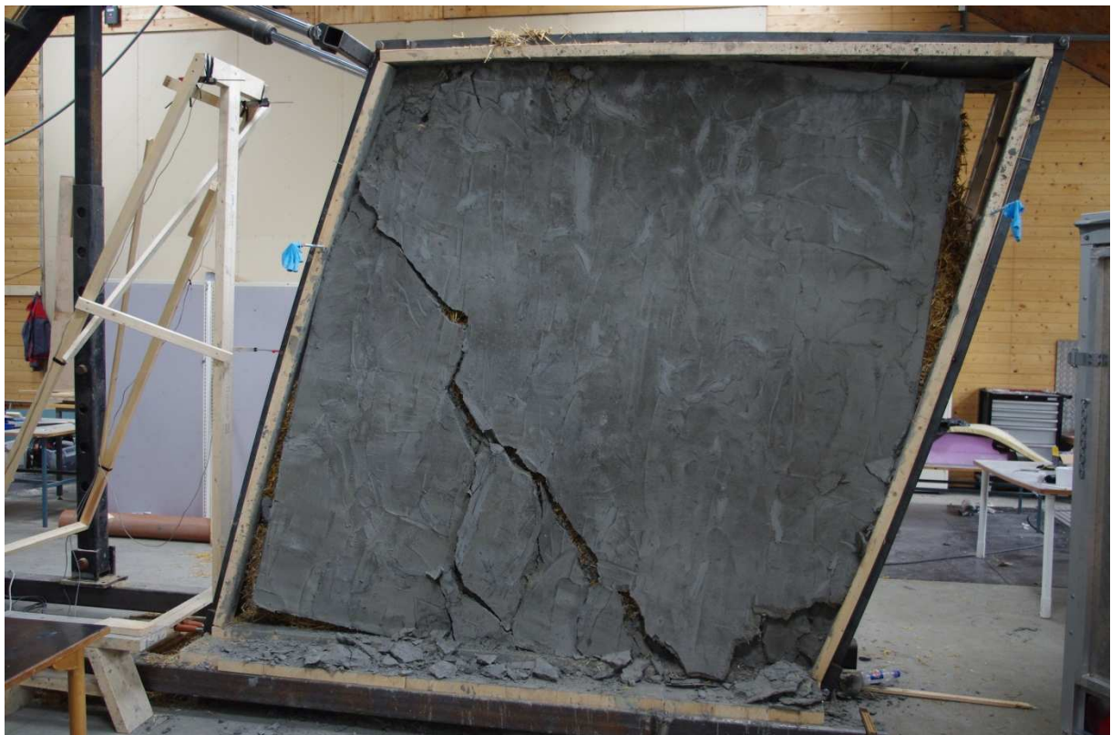
Figur 4.14: Veggen ved maksimal forskyvning. Sett fra styrbord side i forhold til kraftretning.
