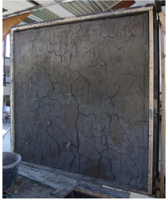
Figur 3.41: Til venstre; vegg etter påføring av andre pusslag. Til høyre; vegg etter tørking av andre pusslag.
