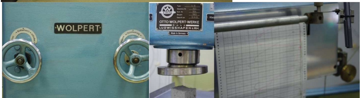
Figur 3.18: Otto Wolpert maskinen i detalj. Fra venstre mot høyre: Kontrollhjul. Trykkstempel over leirkube. Grafeutskrift per penn og papir.
