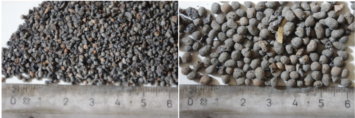
Figur 3.6: Til venstre ses små lecakuler og til høyre ses store lecakuler. Størrelsene var henholdsvis ca 2 og 4 millimeter.
