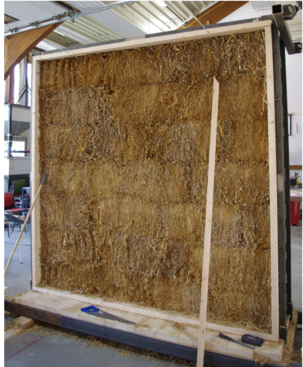
Figur 3.36, over: Halmveggen etter frisering. Det ble anvendt en rettelekte for å sørge for at halmveggen ble planest mulig.
