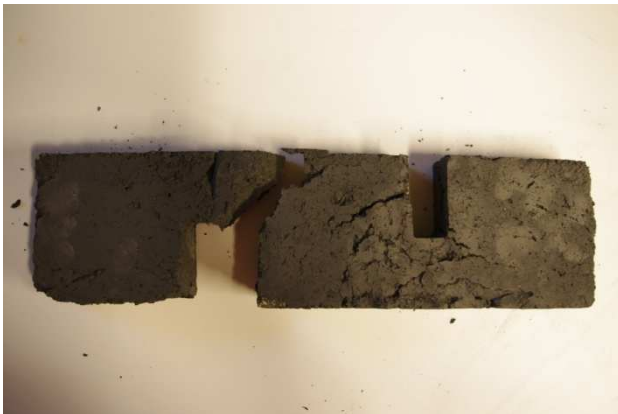
Bilde F2.1: Venstre bilde viser oppsprekking på underside. Høyre bilde viser oversidens oppsprekning
