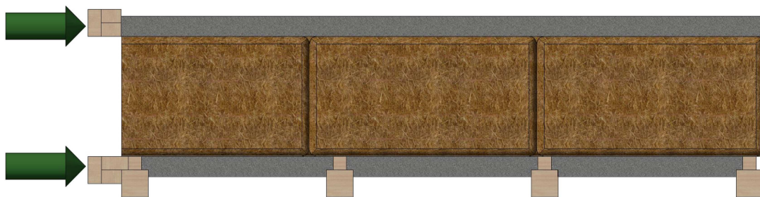
Figur 3.26: Lastinnføringen direkte i leirpussen. Øverst vises leirpuss på utsiden og nederst vises veggens innsidige leirpuss. Kraften påføres i senter av hvert pusslaget via fleksible stående stendere.
