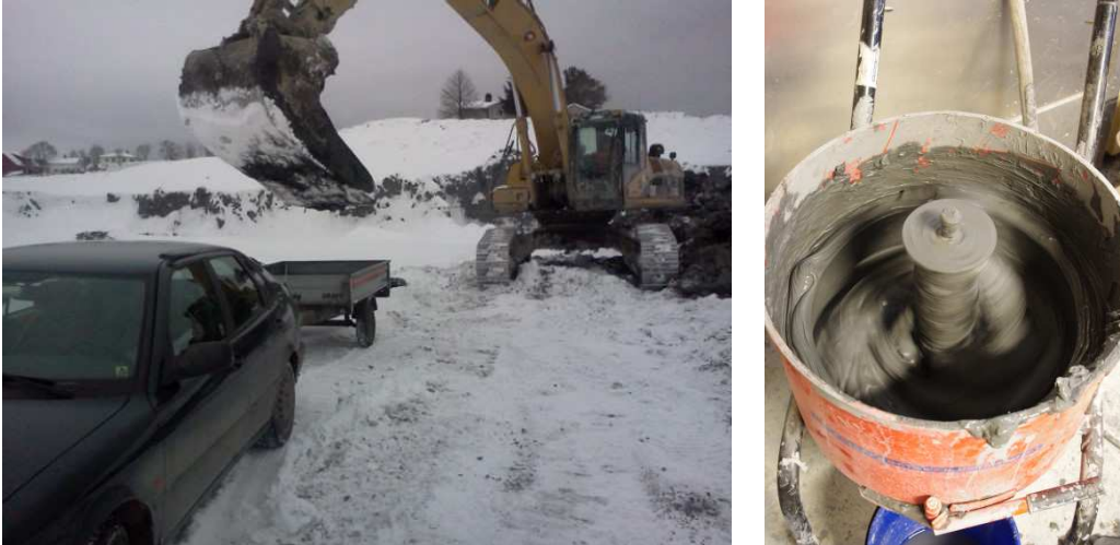
Figur 3.1, til venstre: Leiren dampet av jordvarme i det snøklede vinterlandskapet på Rælingen. Figur 3.2, til høyre: Eltemaskinen på betonglabben hvor eltingen foregikk. All leir ble eltet i halvannen time for å besørge at leira var mest mulig homogen.
