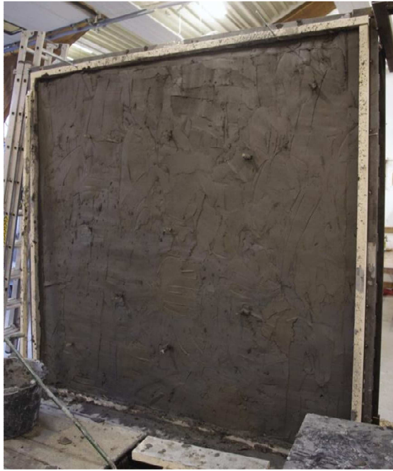
Figur 3.41: Til venstre; vegg etter påføring av andre pusslag. Til høyre; vegg etter tørking av andre pusslag.
