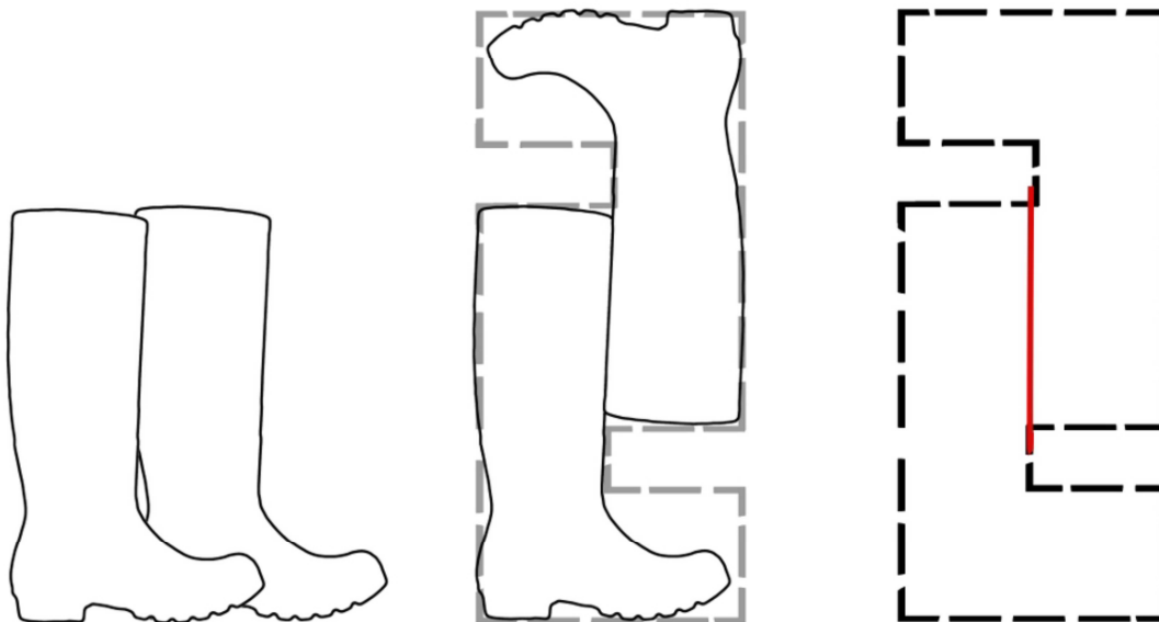
Figur 3.12: Støvelprøve. Man ser for seg en sammensetning av to støvler hvor skjærsonen vil gå der støvlene møtes (markert rødt).
