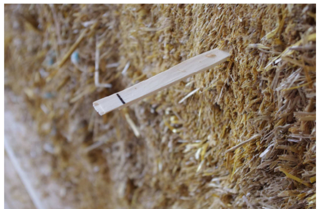
Figur 3.37, til høyre: Målepinne innsatt i halmveggen. Den svarte stripen markerer 10 cm fra halmveggen slutt.
