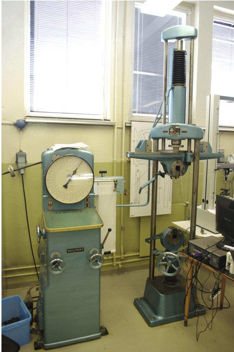
Figur 3.17: Til trykktestingen ble en hydraulisk testmaskin benyttet.
