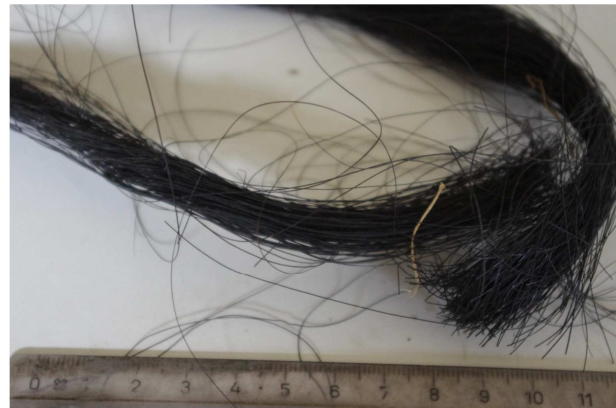
Figur 3.9: Hestehalehåret ble kuttet opp før anvendelse
