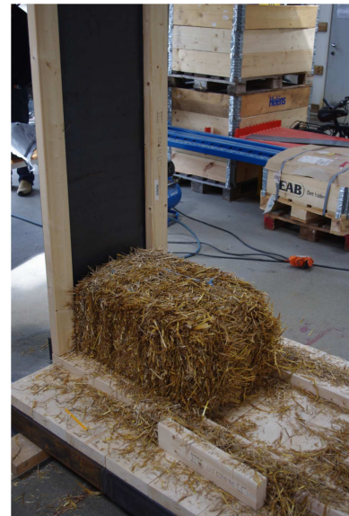
Figur3.31, over: Trerammene som omkranset leirpussen. Her vist med en halmball imellom.
