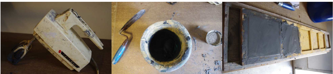
Figur 3.11: Med enkle hjelpemidler ble mørtelen blandet og prøvene satt. Håndmikser, murerkje og desilitermåle. Lengst til høyre: Pussprøveform.
