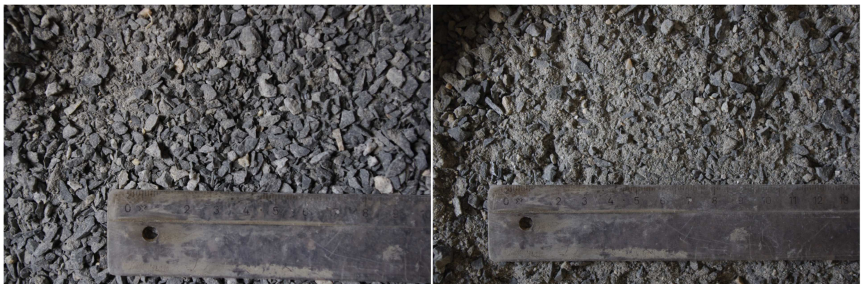
Figur 3.5: Til venstre ses subusblanding med kornstørrelse 4 mm som største korn. Til høyre ses subusblanding med 8 mm som største kornstørrelse.
