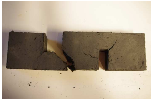
Bilde F2.1: Venstre bilde viser oppsprekking på underside. Høyre bilde viser oversidens oppsprekning
