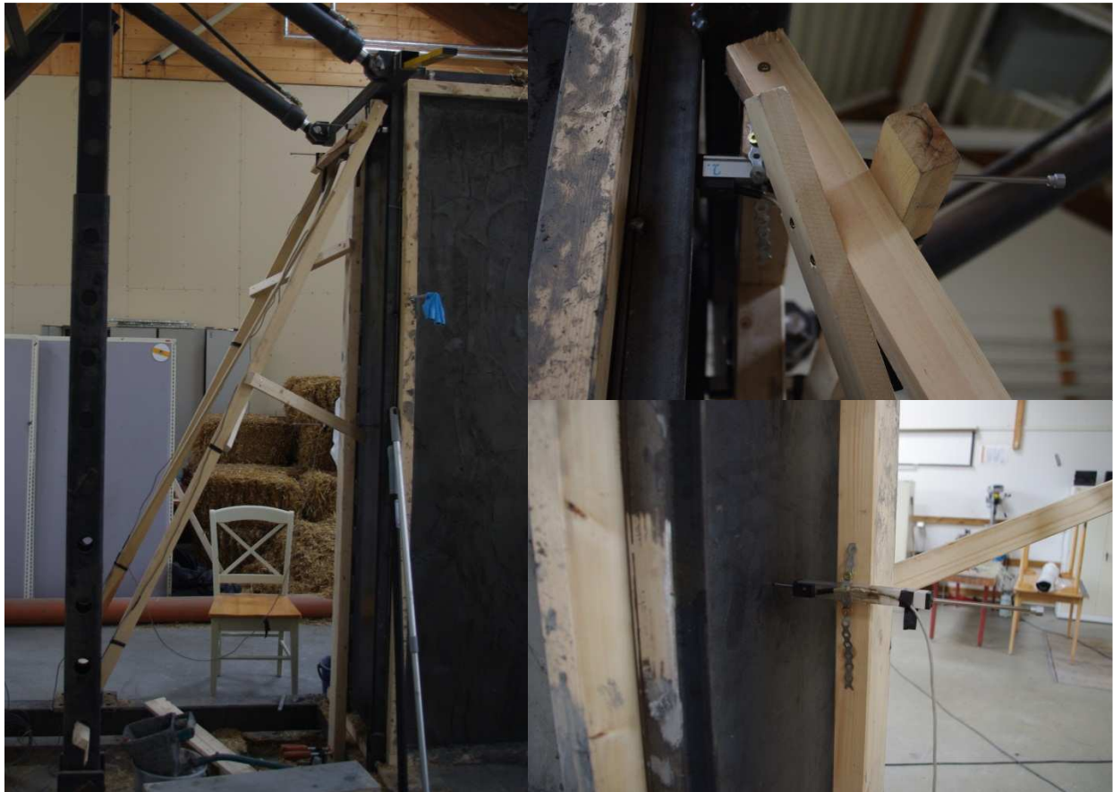
Figur 3.45: Frittstående måletårn for horisontal forskyvning. Figur 3.46: Øverst: Sensor 1. Nederst: Sensor 3.
