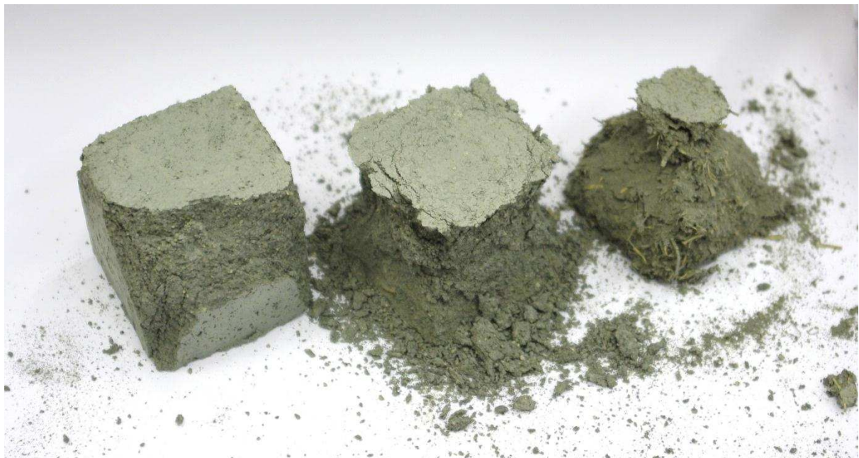
Figur 4.6: Bruddformer oppnådd under trykktesting. Tre av de sterkeste prøvene. Fra venstre: 1. mye isofiber. 2. mye isofiber. 3. mye halm.
