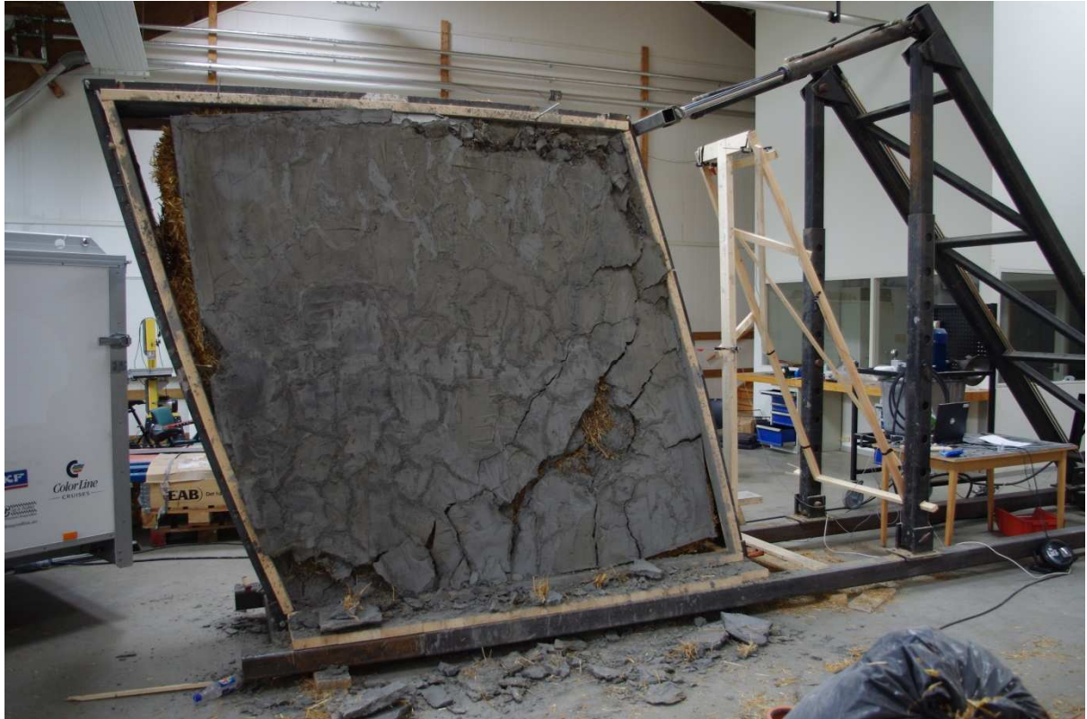
Figur 4.13: Veggen ved maksimal forskyvning. Sett fra babord side i forhold til kraftretning.
