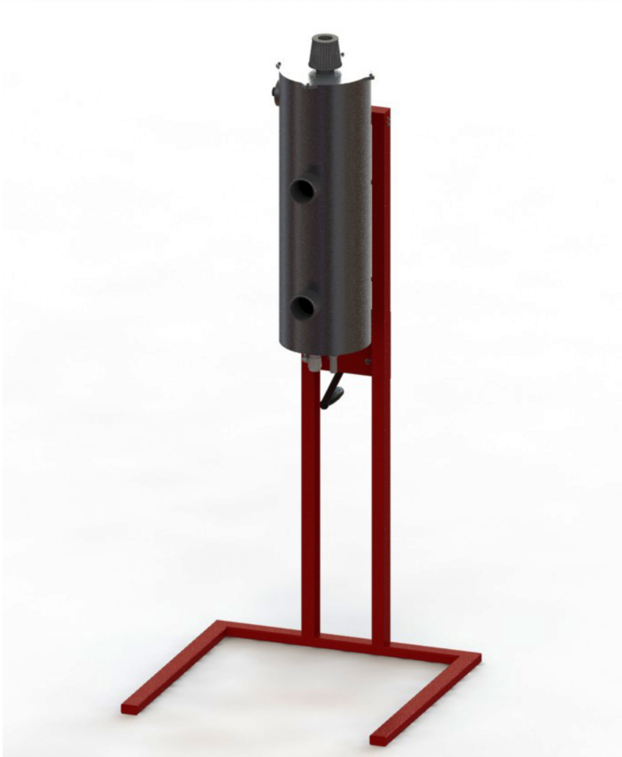
Figur 115: Rendrening av kjølekolonnen på lakkert stativ, sett forfra.
