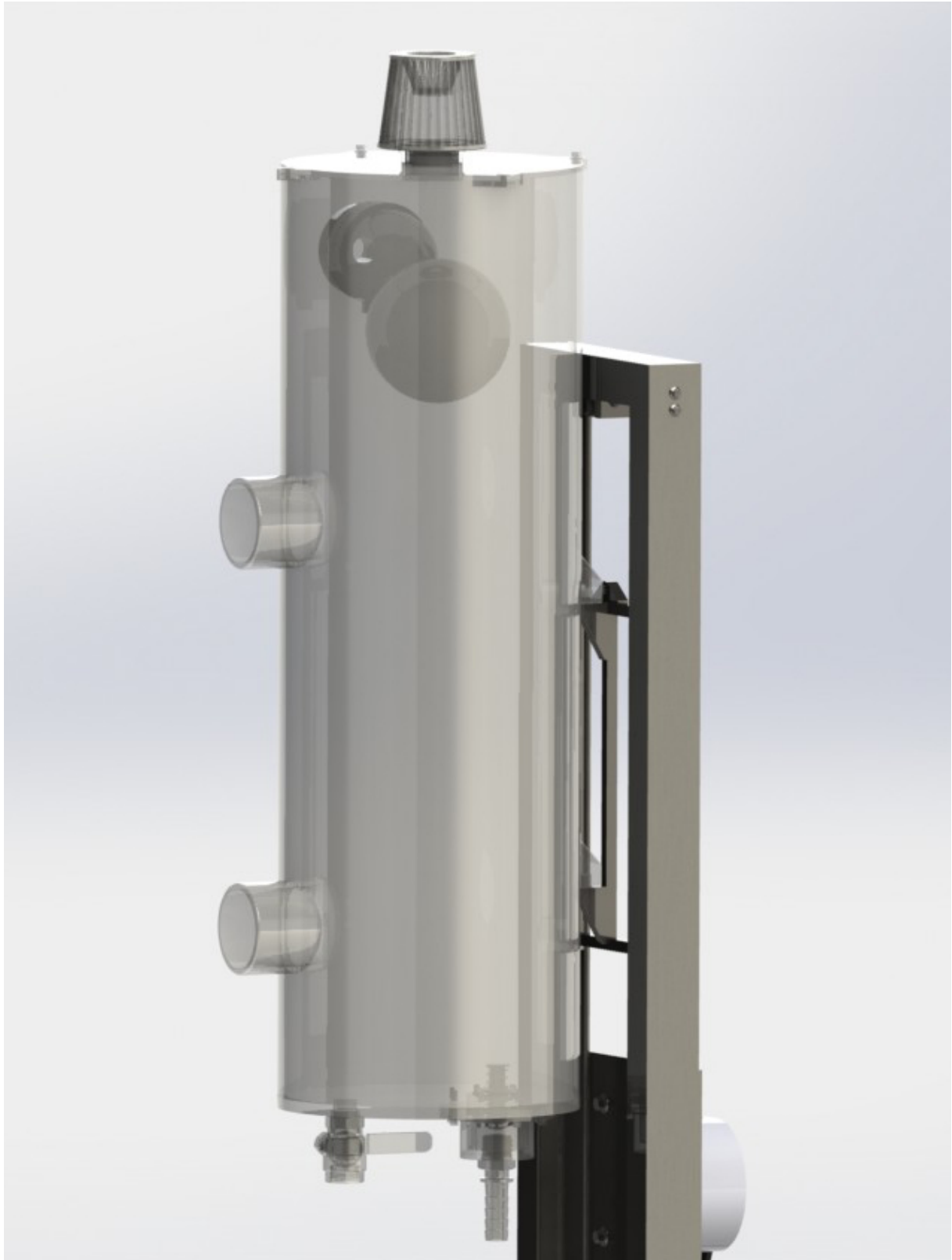
Figur 118: Kjølekolonnen er gjort gjennomsiktig for å få oversikt over komponenter på innsiden av sylindren. Flottørventilen vises tydelig i toppen. I bunnen vises det tydelig hvordan den temperatursensitive enden av termostaten stikker opp i sylindren.
