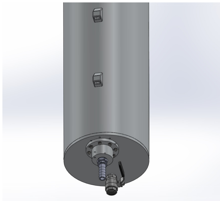
Figur 25: Kjølekolonnen sett bakfra. Det er to festebraketter montert over hverandre.
