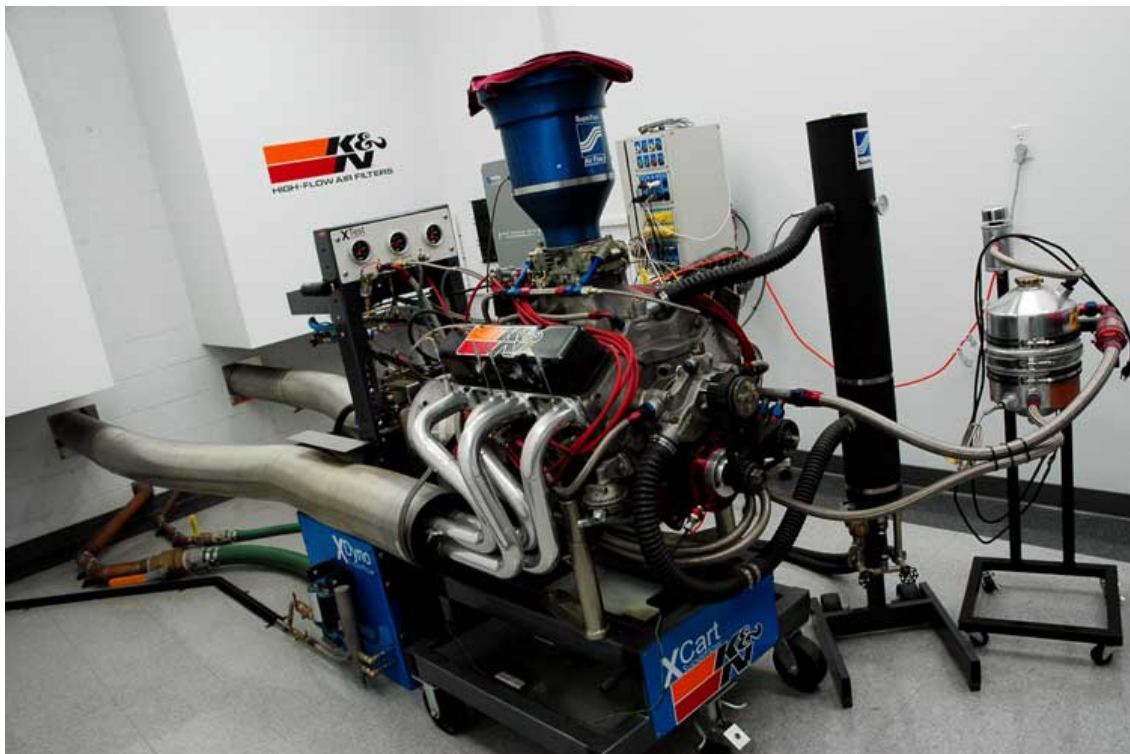
Figur 1: Motor i testbenk. Kjølekolonnen er den sorte sylindren som står på stativ med hjul til høyre for motoren [1.1].
