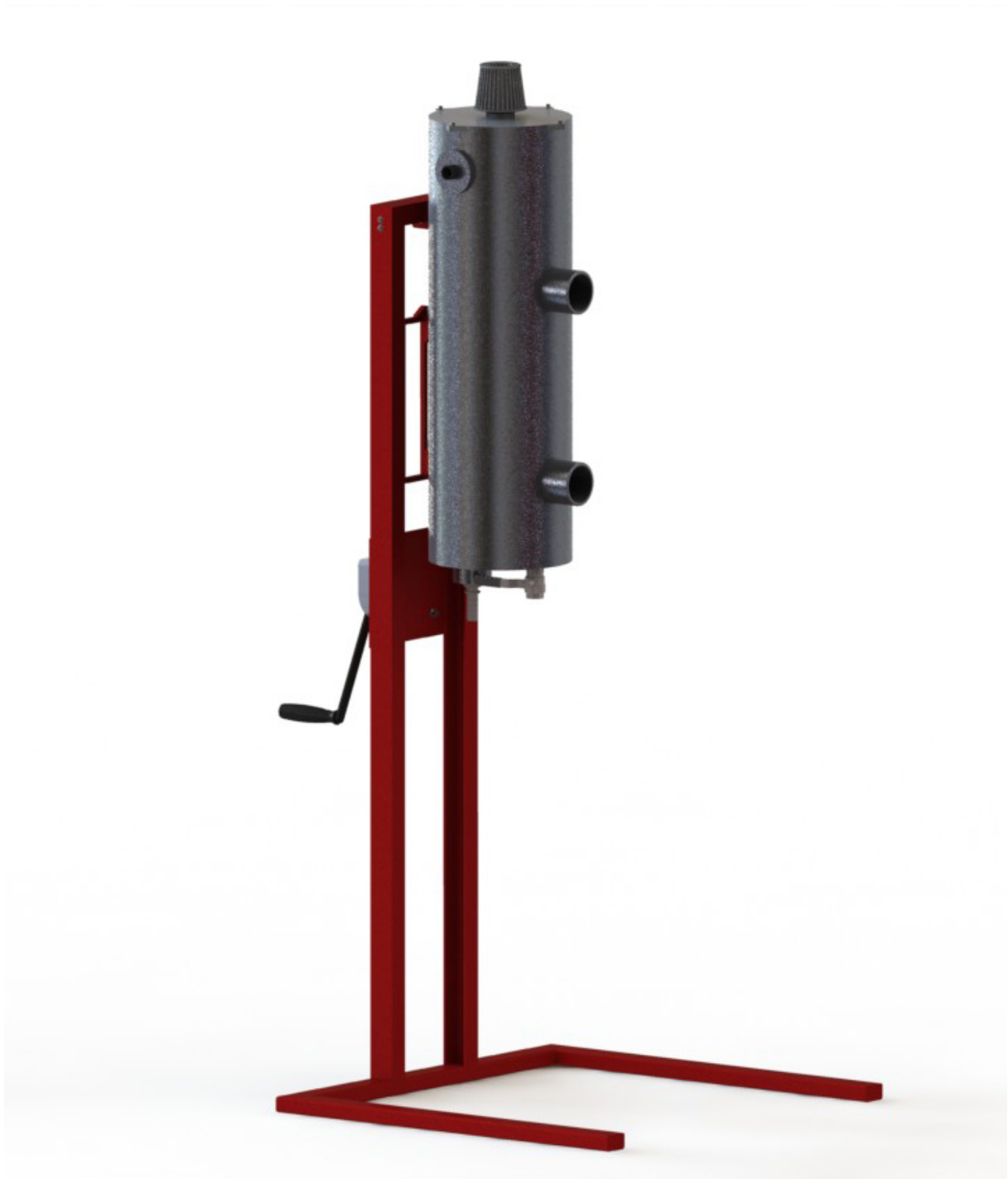
Figur 117: Rendring av hele sammenstillingen. Figuren viser tydelig alle kjølekolonnens tilkoblingspunkter.
