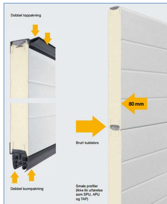
Figur 22 Detaljsnitt DPU-port [Hörmann]
