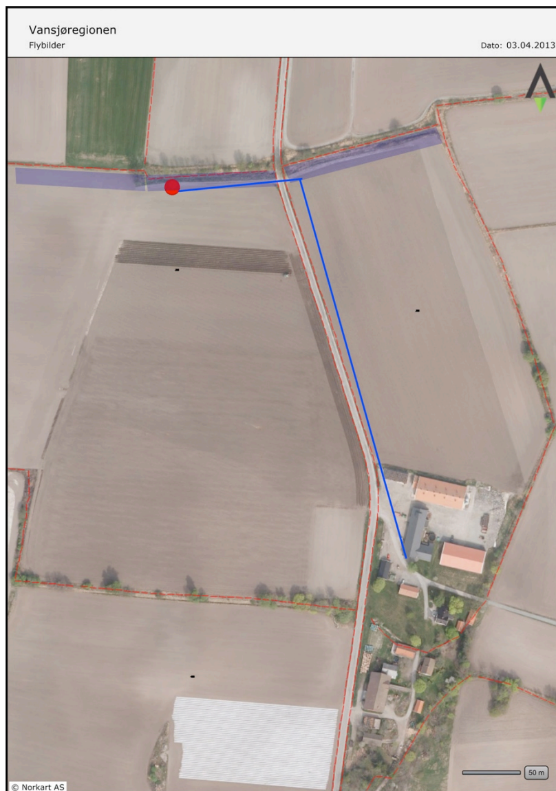
Figur 22 - Plassering av turbin merket med rødt. Blått felt er aktuelle plasseringer og blå strek er jordkabel frem til gården[49]
