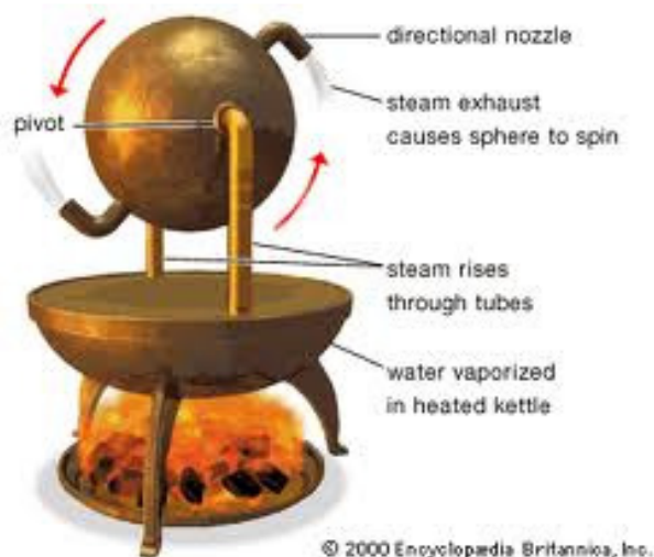
Eolipile (Heronkula)- den første kjente varmekraftmaskin i historien.
